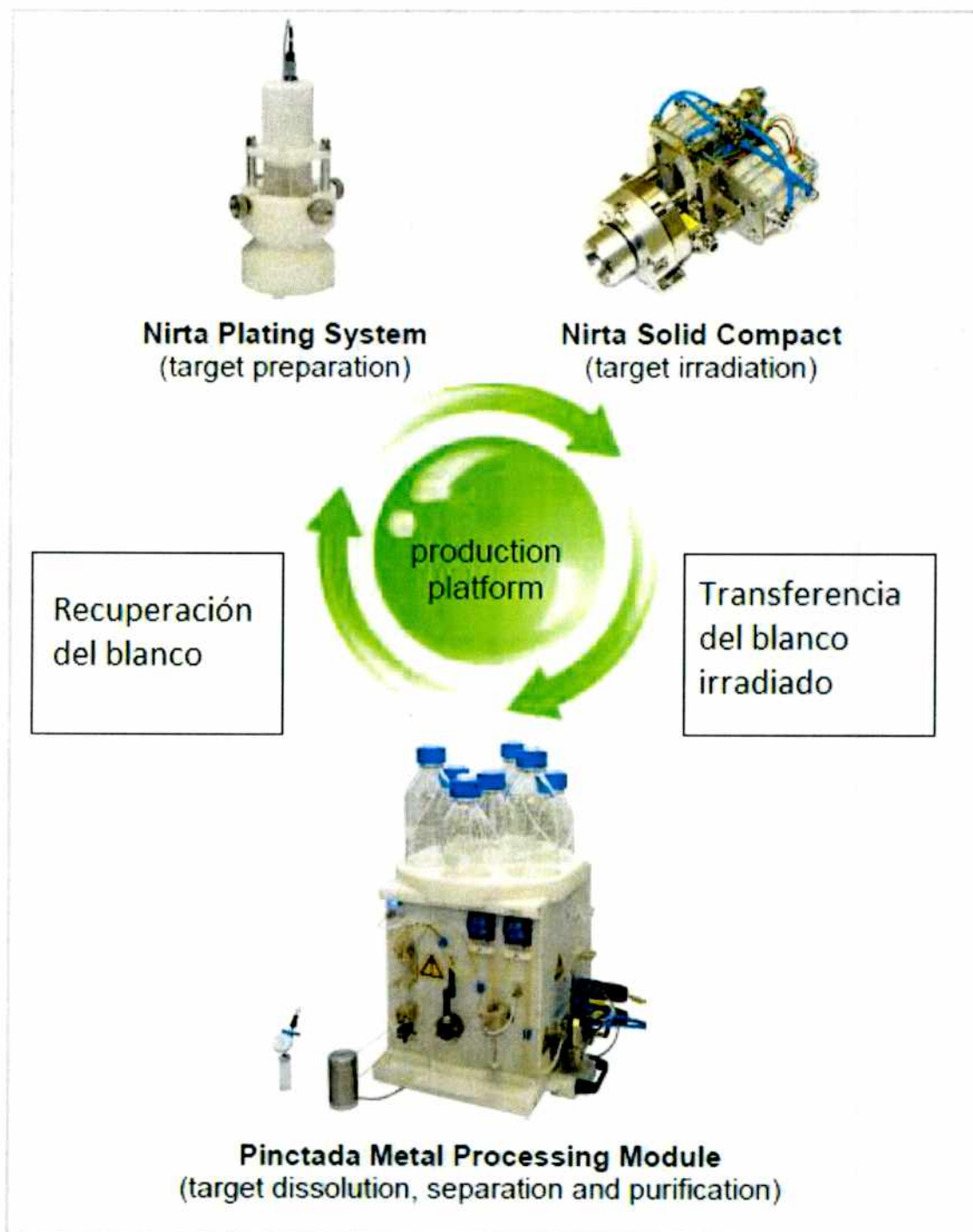
Figura 24: Plataforma de producción Pinctada (IBA) para la producción de radiometales.
