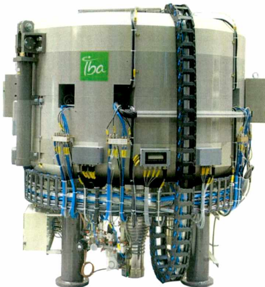
Figura 18: Ciclotrón IBA Cyclone 18
