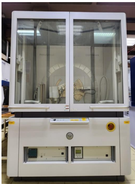
Figura 3.12. Equipo de XRD usado para el estudio cristalográfico de los materiales
