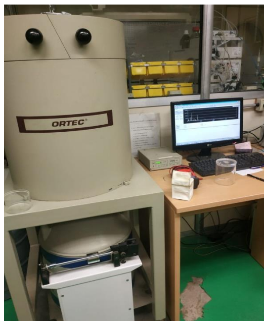
Figura 3.20. Equipo de espectrometría gamma utilizado para la cuantificación de los radioisótopos generados en la irradiación de la muestra en el reactor RA-3
