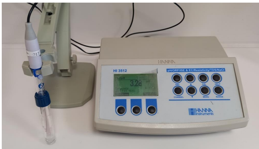
Figura 3.1. Equipo medidor de pH con electrodo combinado de vidrio
