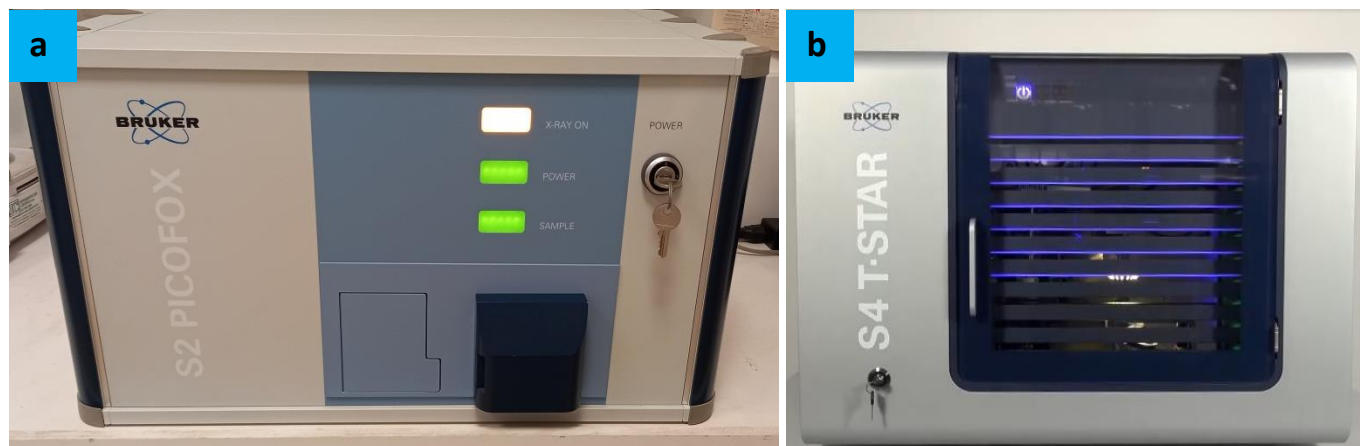
Figura 3.6. Equipos de TXRF empelados para el análisis elemental de las muestras a) S2 PICOFOX y b) S4 T-STAR
