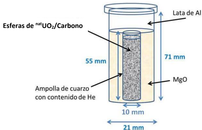
Figura 4.41. Esquema del dispositivo con las microesferas de \text{UO}_2 /Carbón a irradiar
