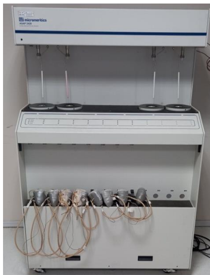
Figura 3.14. Equipo de porosimetría utilizado para determinar el área superficial y porosidad de los materiales sintetizados
