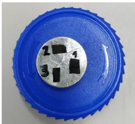
Figura 2. 9. Soporte de aluminio con cintas de carbón doble faz y muestras en polvo depositadas sobre la superficie.
