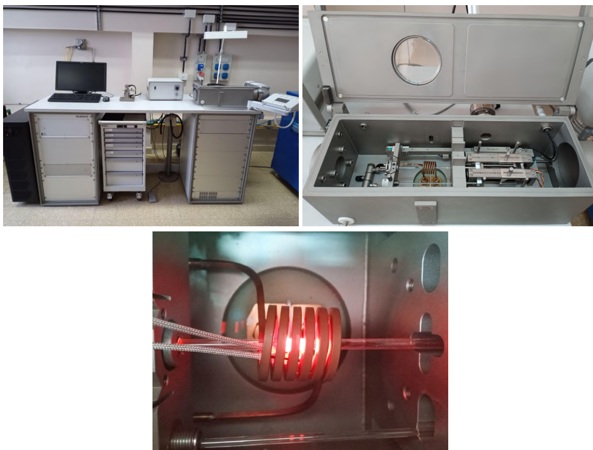
Figura 3.2: Dilatómetro TA Instruments DIL 805A, División Transformaciones de Fases, Gerencia Materiales, Comisión Nacional de Energía Atómica.
