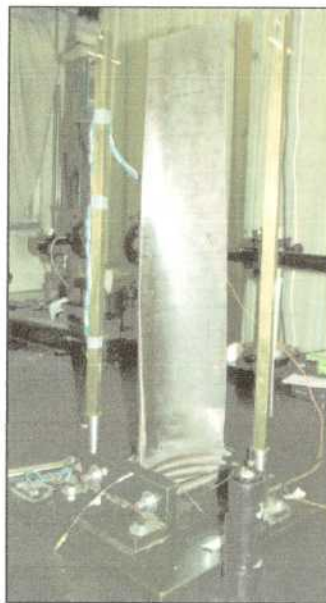
Figura 4.21. Líneas de referencias sobre la superficie de presión del álabe para la ubicación de sensores.
