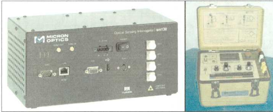
Figura 4.39. Equipos de medición de deformaciones. Izquierda: sistema de fibra óptica.
