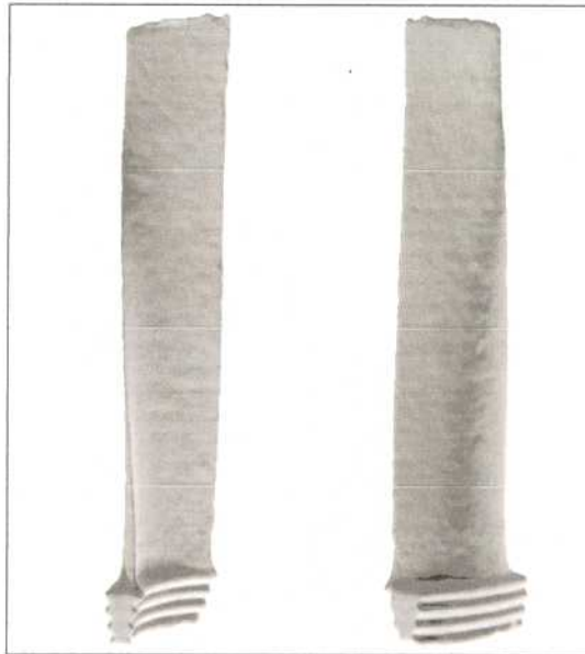
Figura 4.4. Resultado del escaneo del álabe rotatorio de turbina de vapor de tercera etapa de CNA-I.
