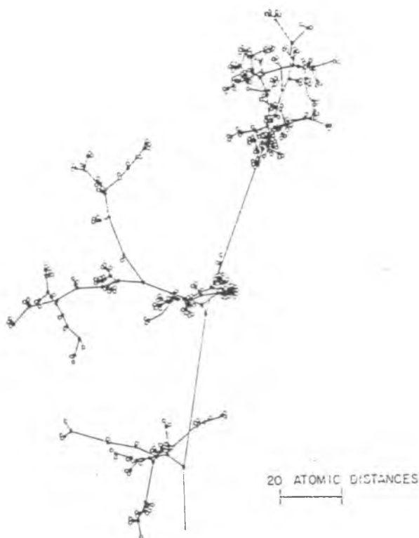
Figura 2-2: vacancias (círculos vacíos) e intersticiales (círculos llenos) producidas en germanio calculadas por la teoría de producción de cascadas. 2-2
