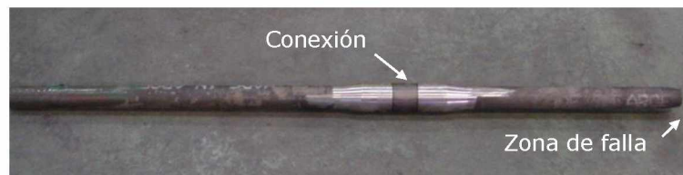
b) VBH # 2 (Rotura en el cuerpo del tubo)
