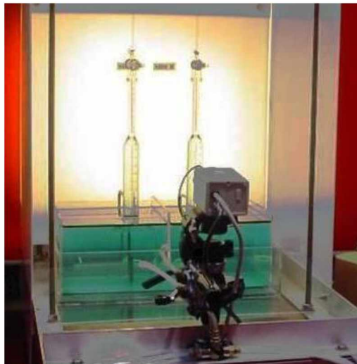
Figura 107: Vista de los detectores de pérdidas de presión interna
