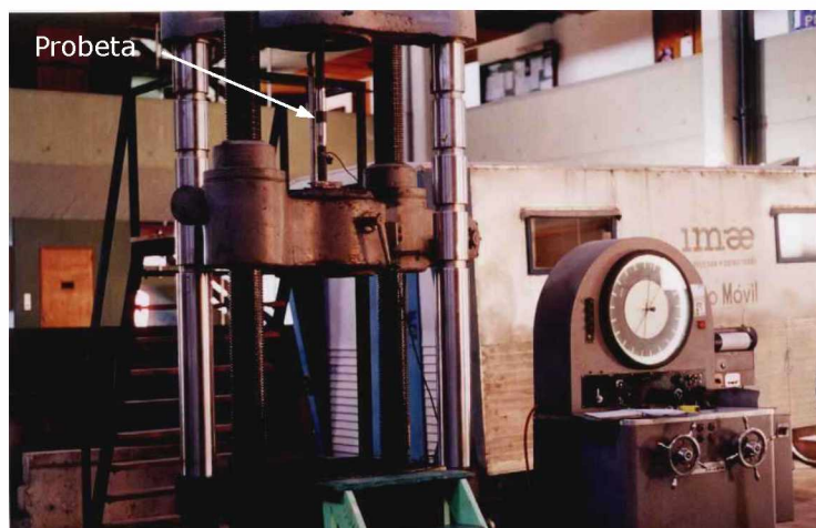
Figura 71: Máquina de ensayo de tracción a rotura
