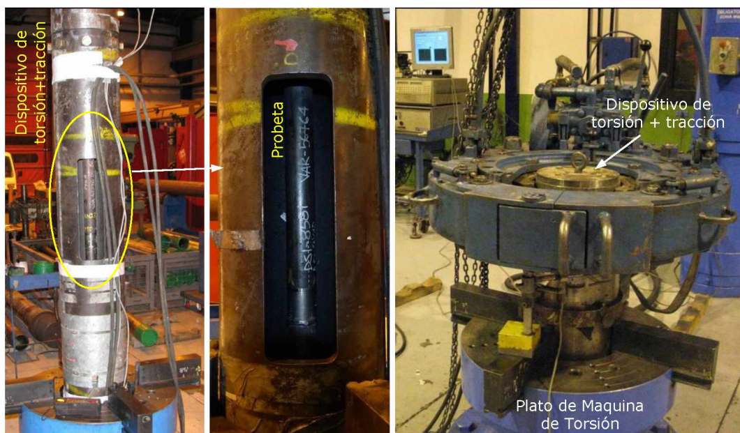
a) Montaje del dispositivo, b) Detalle de la probeta, c) Durante el ensayo
