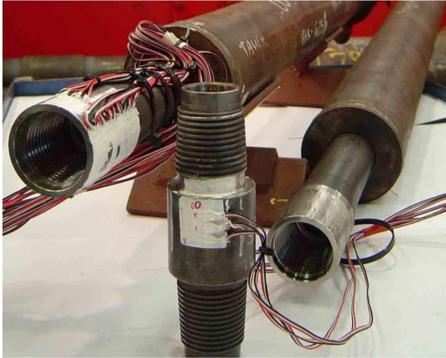
Figura 66: Probeta instrumentada con strain gages (VBH 42x5 Rec. 50)
