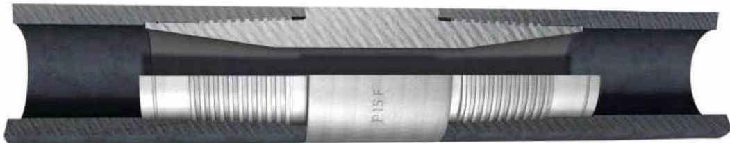
b) VBH #5 (48x6 liso externamente con niple mejorado). Niple con sello interno y alta interferencia radial en la zona de rosca.
