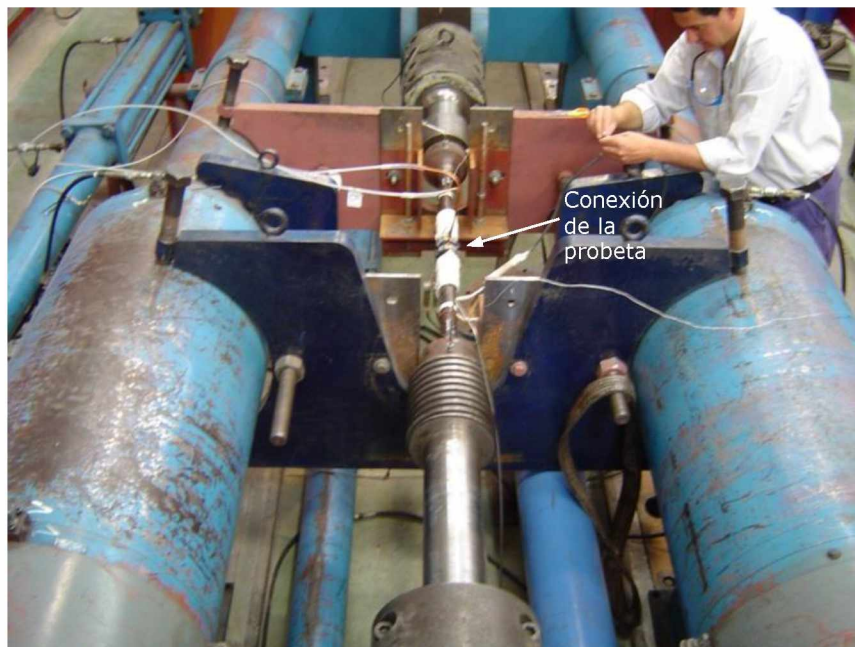
Figura 105: Probeta montada en la máquina de sellabilidad
