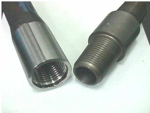
b) VBH #2: \varnothing 42 mm x esp. 5 mm con recalque externo, \varnothing 50 mm
