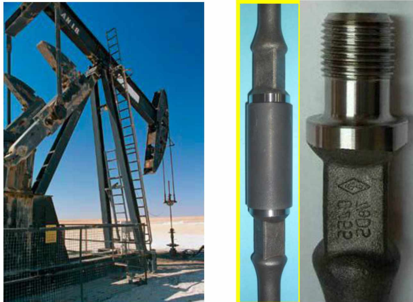
c) Balancín o cigüeña d) Conexión de varilla de bombeo maciza. Detalle de la rosca
