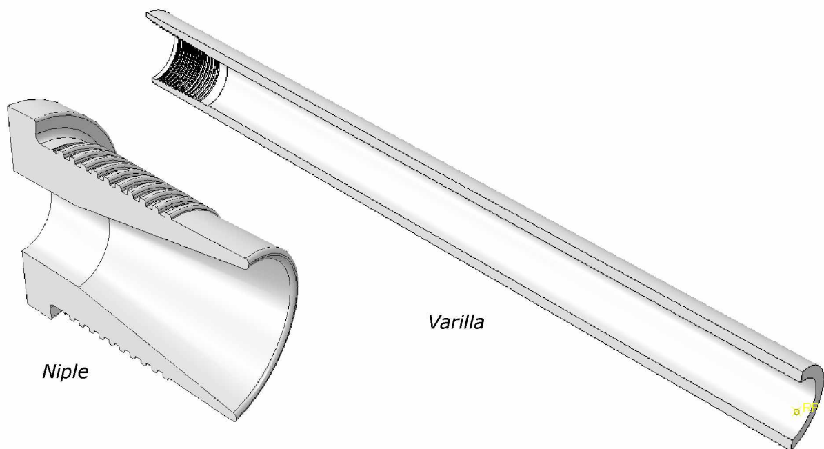
Figura 53: Partes solidas de la conexión: Niple y varilla de la VBH #4 (48x6 externamente liso con niple mejorado)
