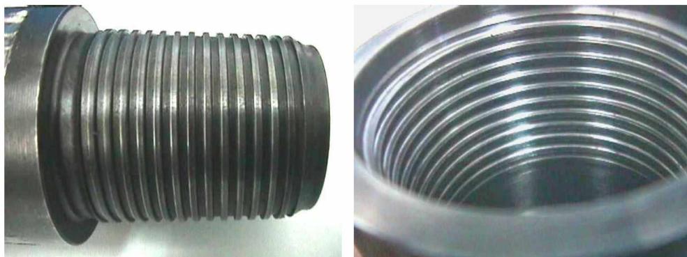
a) VBH #2 (Prob. 1). Vista de Niple y Varilla
