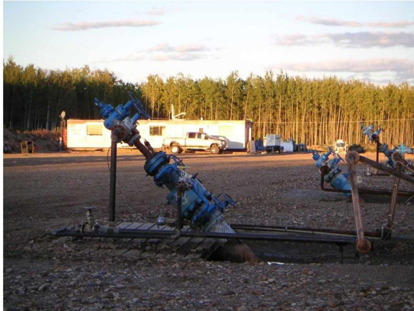
Figura 109: Pozo petrolero desviado utilizando una columna varillas huecas en Canadá.
