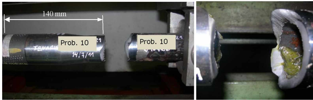
Figura 102: Probeta de VBH #2 (Prob. 10) luego del ensayo de fatiga multiaxial. La falla se produjo en la zona del cuerpo de la varilla.
