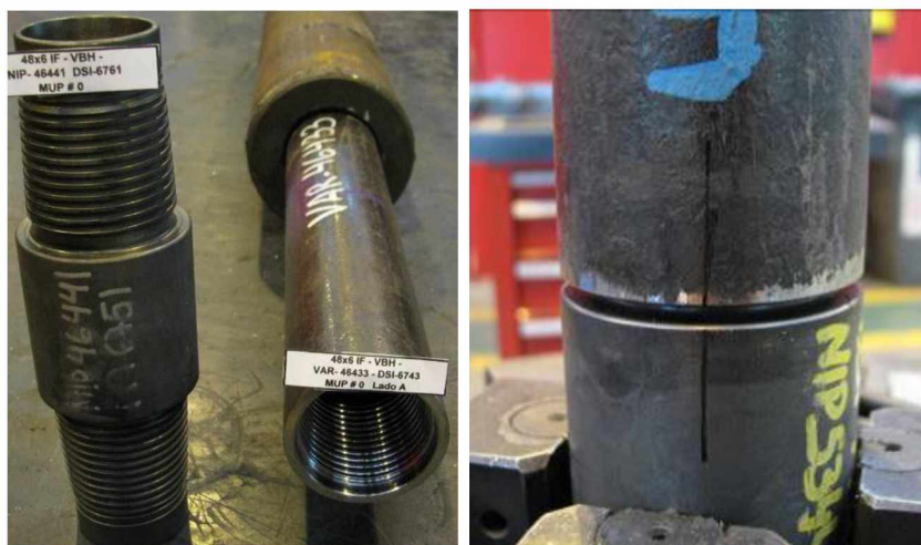
Figura 76: Probeta del ensayo de torsión a rotura sin carga axial
