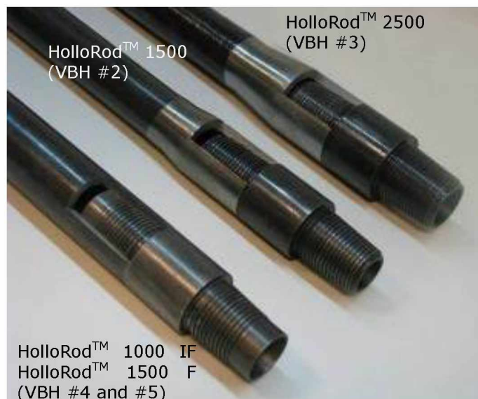
Figura 70: Prototipos de Varillas Huecas, VBH #2 a #5
