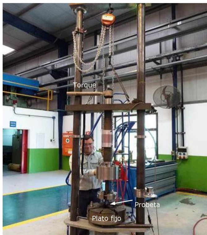
Figura 79: Dispositivo de apretado de conexiones (Laboratorio I&D Tenaris Siderca)
