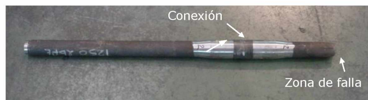
c) VBH # 3 (Rotura en el cuerpo del tubo)
