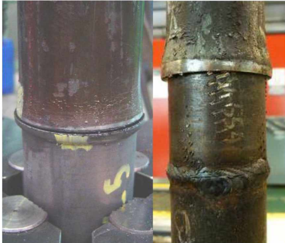
d) VBH #4 (Prob. 2, torsión y Prob. 4, torsión combinada con tracción)
