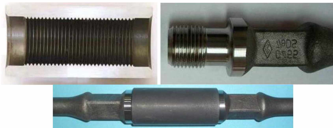
Figura 20: Vista de la superficie de la cupla y varilla API. La cupla presenta fosfatizado mientras que la varilla no.
