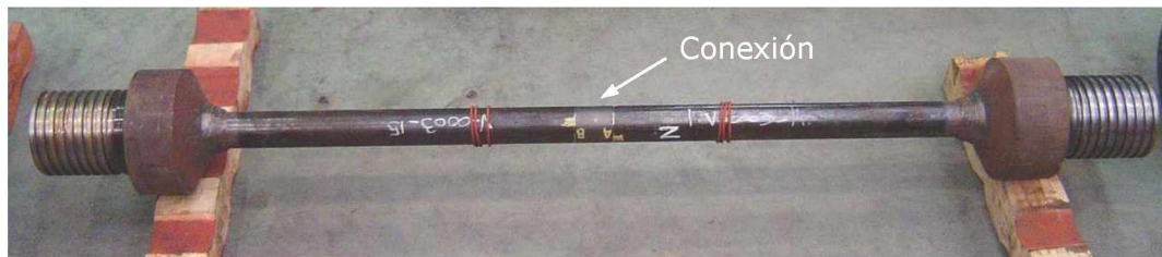
Figura 104: Probeta de ensayo de sellabilidad. Prob. de VBH #4
