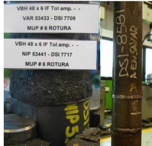
e) VBH #5 (Prob. 6, torsión y Prob. 8, torsión combinada con tracción)
