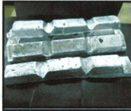
Figura III.3 – Lingotes de aleación eutéctica Al-Cu (aleación madre).
