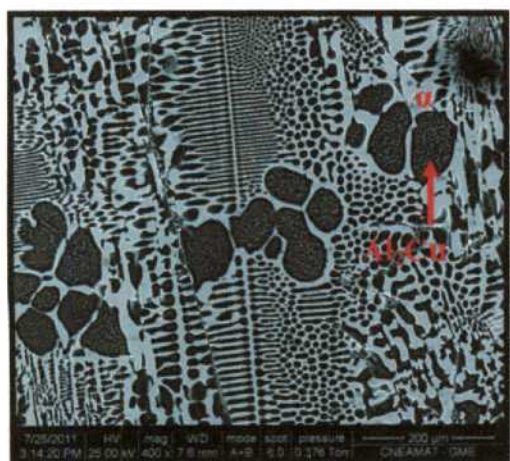
Figura IV.6 – Las micrografías a), b), y c) corresponden a una aleación Al-33,2%Cu (experiencia 17) en las zonas columnar, de TCE y equiaxial, respectivamente.
