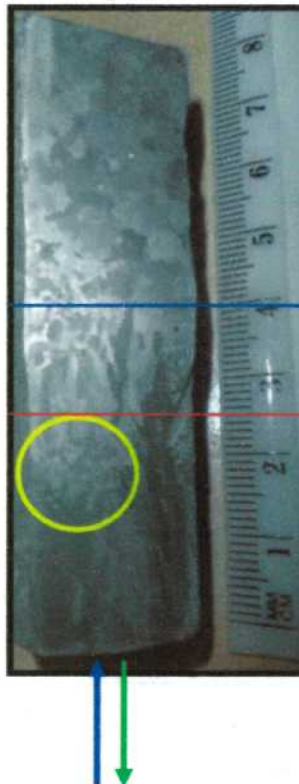
Figura IV.3 – Macrografía de una probeta solidificada unidireccionalmente de una aleación Al-4,5%Cu donde se interrumpe el crecimiento de los granos columnares (zona dentro del círculo amarillo).
