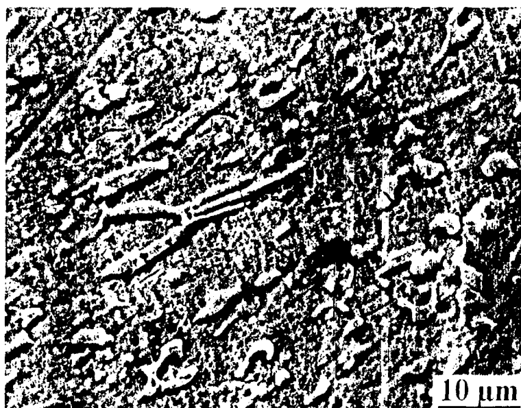
Figura 3.6 M20-800. micrografía (1280x) tomada con MEB. Granos claros de fase \Theta , insertos en una matriz más oscura mayoritariamente compuesta de las fases Zr_2Fe y Zr_3Fe .
