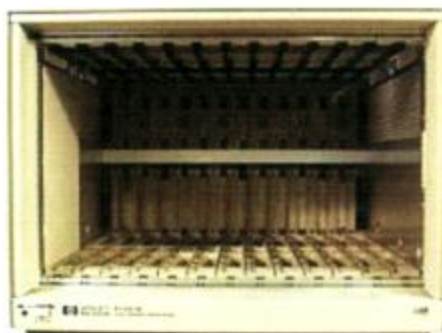
Figura 26. Muestra de las ranuras de la unidad central de alta energía HP-Agilent E1401B.
