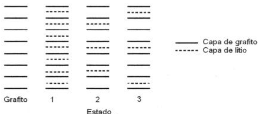
Figura 15. Diagrama esquemático del apilamiento de litio en grafito.
