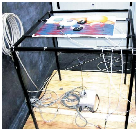
Ubicación de la obra de arte, fuente de radiación y película.
