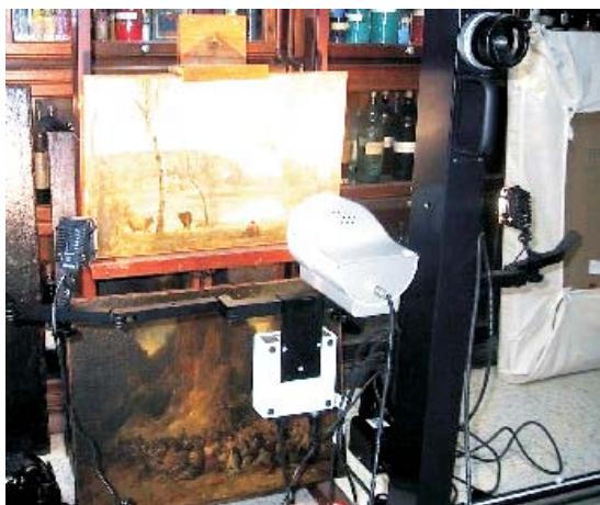
Sistema de montaje del equipo MUSIS
