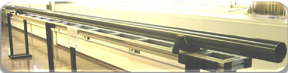
Figura I.5.a) Planta Piloto PPFAE, perteneciente al Departamento de Tecnología del Circonio (DTC-CAE-CNEA), donde se realizó el proceso de laminación en frío HPTR de los tubos de presión utilizados en el proyecto de extensión de vida de la Central Nuclear Embalse (CNE). b) Fotografía de Tubo de presión de Zr-2.5%Nb terminado.
