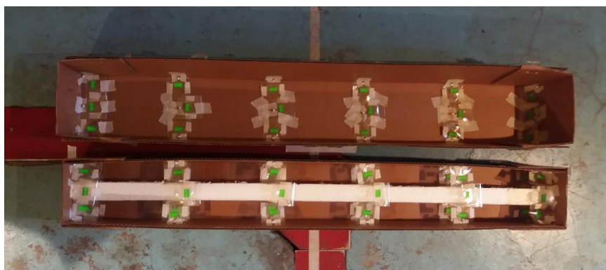
Figura 2.15 Colocación de dosímetros en las cajas vacías de gypsophila de exportación
