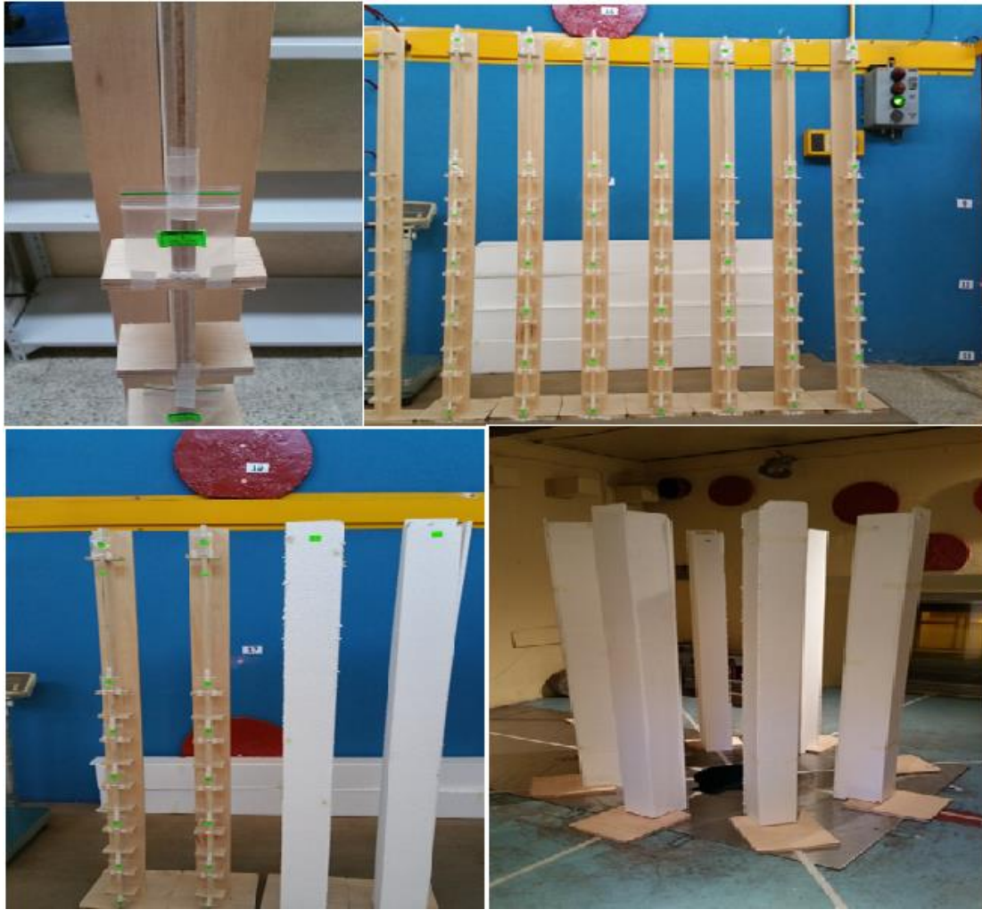
Figura 2.12. Preparación y ubicación de dosímetros en soportes
