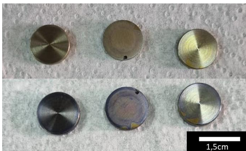
Figura 4.3.4. Imágenes ópticas de muestras TF preparadas por spin coating antes (arriba) y después (abajo) de su inmersión en azul de metileno. A la izquierda, film preparado a 3000 rpm, en el centro a 4500 rpm y a la derecha a 6000 rpm.
