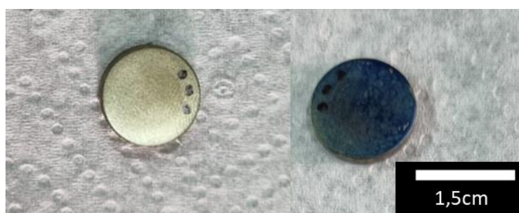
Figura 4.2.11. Imágenes ópticas del FDM SF-atemporal antes (izquierda) y después (derecha) de su inmersión en azul de metileno.
