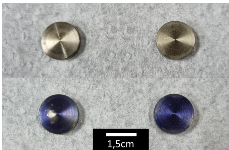
Figura 4.3.9. Imágenes ópticas del FDM: TB-atemporal antes (arriba-izquierda) y después (abajo-izquierda); TF-atemporal antes (arriba-derecha) y después (abajo-derecha) de su inmersión en azul de metileno.
