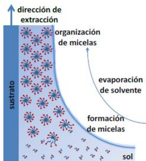
Figura 1.2.4. Esquematación del proceso de autoensamblado de moléculas anfífilas inducido por evaporación. Tomado de referencia 18.
