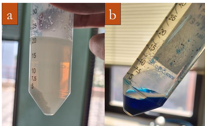
Figura 5.3.1. Fotografías de las nanopartículas antes (a) y después (b) de la incorporación de azul de metileno.
