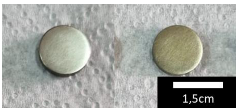
Figura 4.2.1. Fotografías del sustrato antes (izquierda) y después (derecha) del tratamiento térmico, donde se observa el cambio en su coloración.
