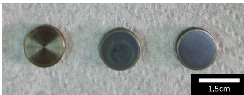
Figura 4.4.1. Imágenes ópticas correspondientes a los films de ZF preparados por spin coating a 3000, 4500 y 6000 rpm (de izquierda a derecha, respectivamente).
