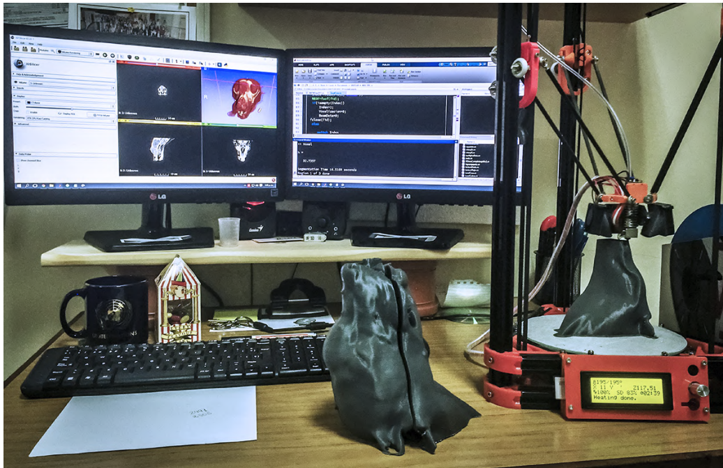
Figura 6.3: Impresión del modelo tridimensional del paciente veterinario con impresora FDM.
