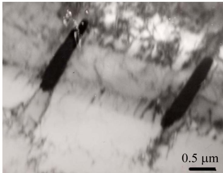
Fig. 29 Acero 304L deformado. Microscopía Electrónica de Transmisión, martensita \epsilon y \alpha' .
