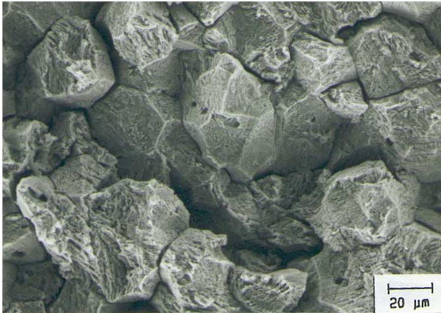
Fig. 27 Fractura acero inoxidable 304 sensibilizado. Ensayo en H 2 S.
