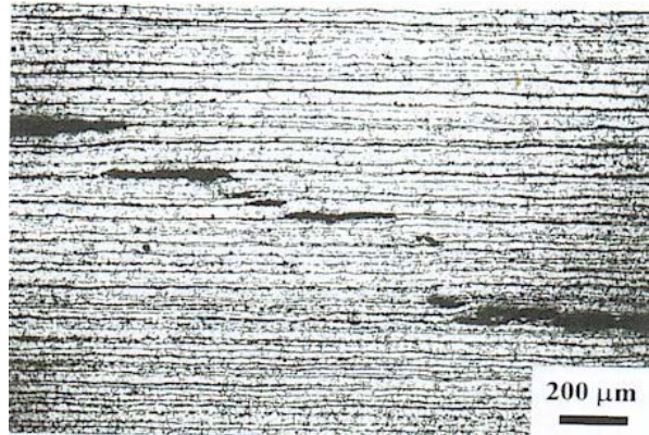
Fig. 15 FIH, fisuras en escalones.
