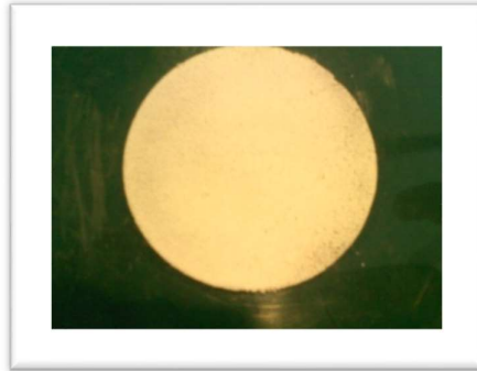
Figura 3.5: Vista superior de las probetas empleadas para el ensayo de compresión.
