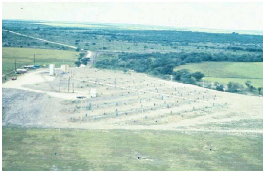
Figura 2: Vista de un yacimiento implementando la lixiviación in Situ.
