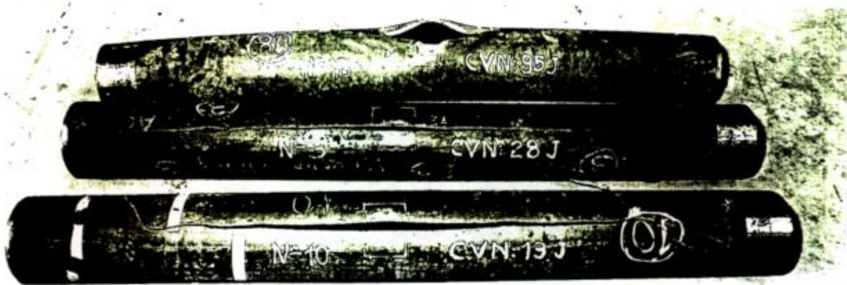
Figura 6-43: Vista de las probetas luego del ensayo de explosión. Identificación: de arriba hacia abajo probetas 95, 28 y 13.
