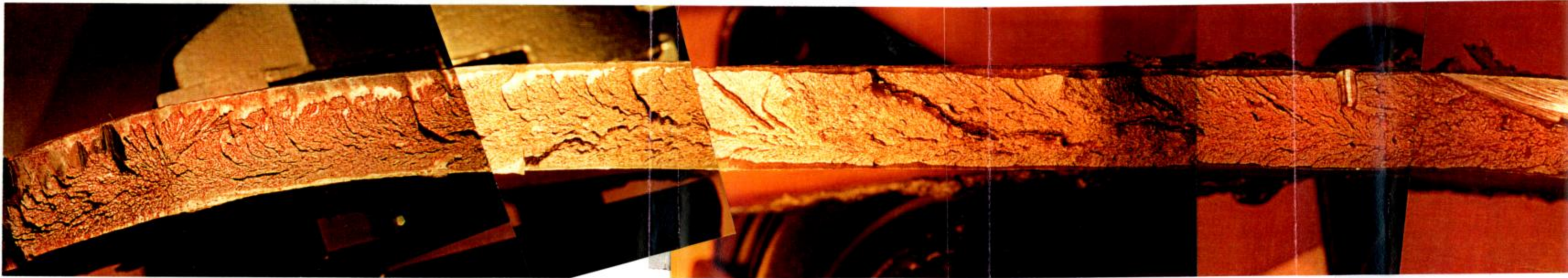
Figura 6-7: Aspecto general de la fractura en la probeta T 1163A.
