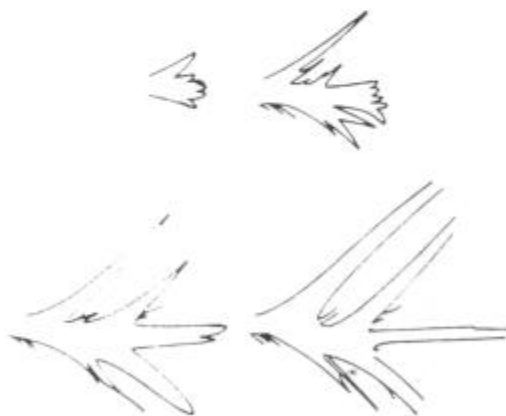
Figura 5-8: Aumento de la separación entre microramificaciones en la punta de la fisura.
