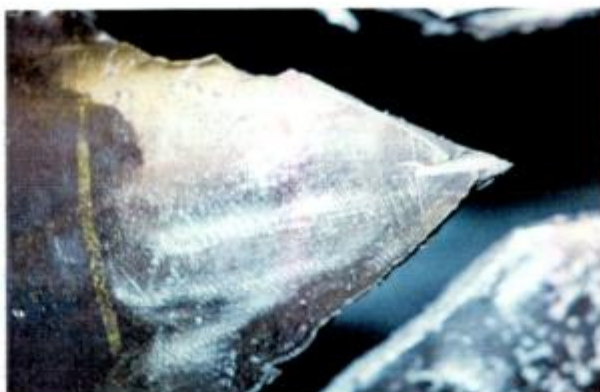
Figura 6-12: Patrón geométrico producido sobre la punta de la entalla al comienzo de la ramificación.
