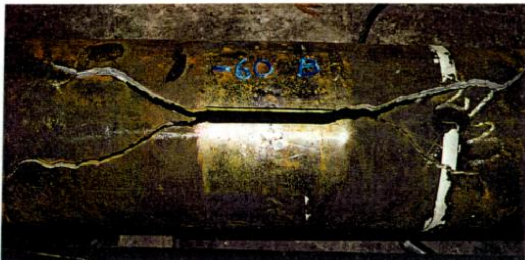
Figura 6-9: Aspecto general de la fractura en la probeta T 1163B.
