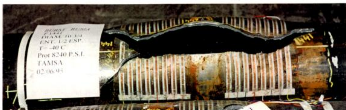
Figura 6-22: Aspecto general de la fractura en la probeta T 1441.
