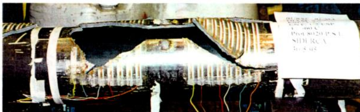
Figura 6-13: Aspecto general de la fractura en la probeta T 1294-3.
