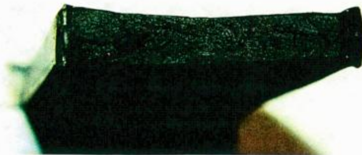
Figura 6-44: Superficie de fractura del ensayo de DWTT en el material TAM 924.
