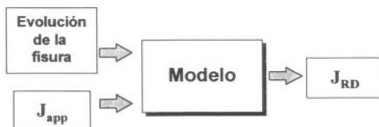
Figura 7-2: Esquema de entradas y salida del modelo aplicado a los ensayos de explosión a plena escala.
