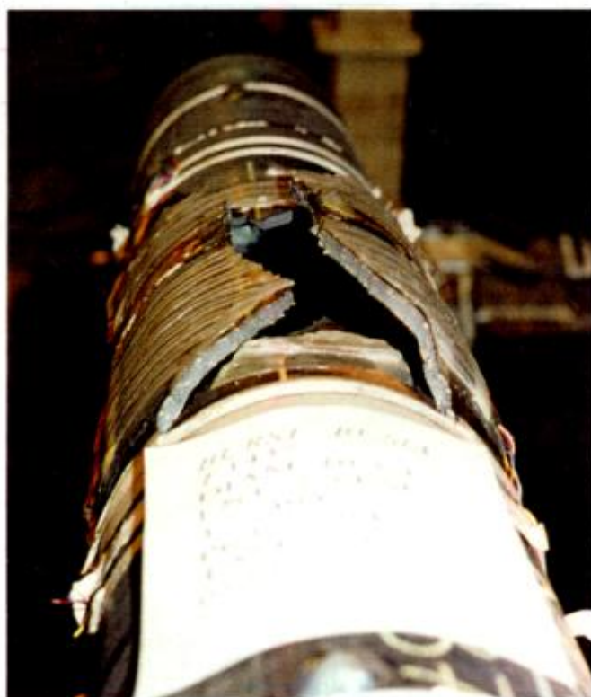
Figura 6-24: Aspecto general de la fractura en la probeta T 1437.
