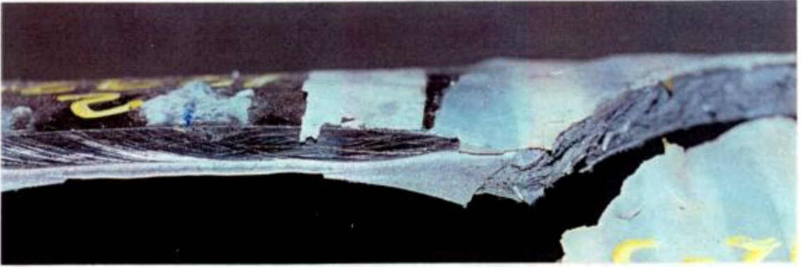
Figura 6-19: Aspecto de la zona de entalla inicial y comienzo de la propagación axial en la probeta T 1292-3.
