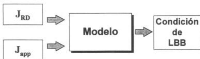
Figura 7-3: Esquema de entradas y salida del modelo aplicado a los ensayos de explosión a plena escala una vez hallada la tenacidad dinámica del material.
