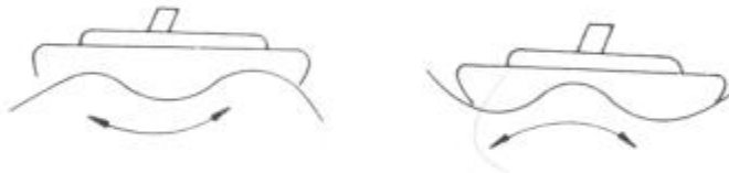
Figura 1-2: Cargas de fatiga por flexión debidas a las olas en el mar.
