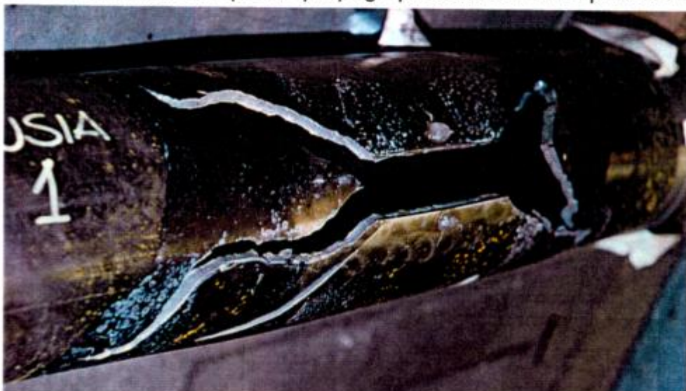
Figura 6-11: Aspecto general de la fractura en la probeta T 1294-1.
