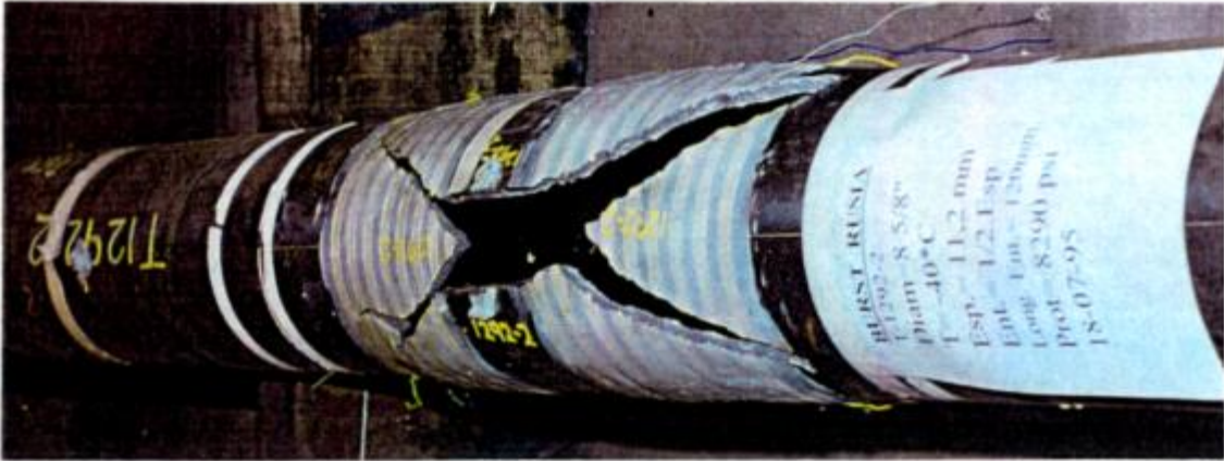
Figura 6-16: Aspecto general de la fractura en la probeta T 1292-2.
