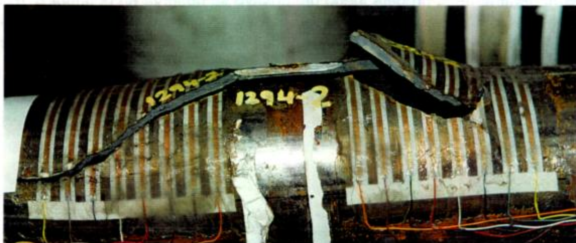
Figura 6-14: Aspecto general de la fractura en la probeta T 1294-2.
