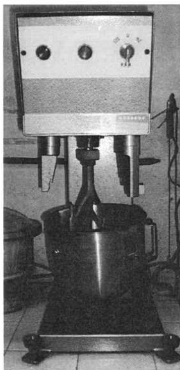
Figura 2.1: Fotografía de la mezcladora de mortero utilizada.
