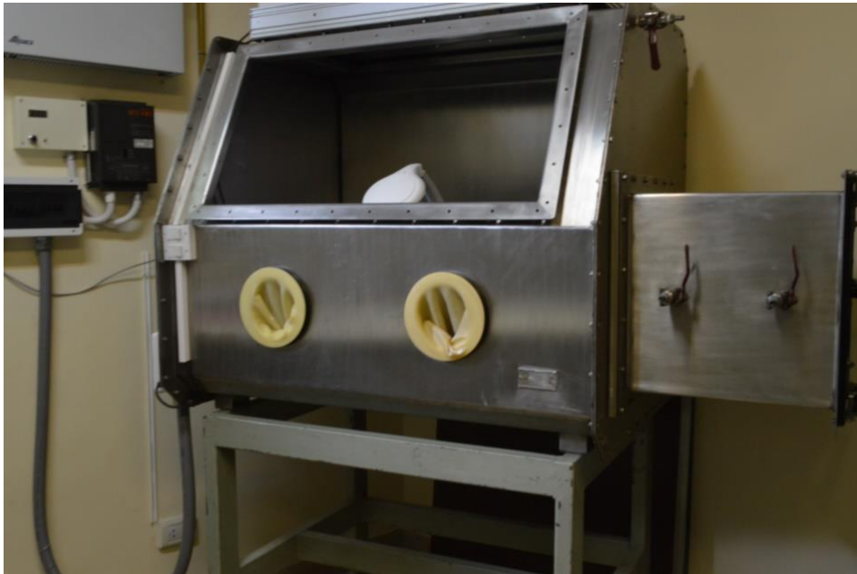
Figura 2.14: Imagen de la caja de guantes utilizada para trabajar con el material irradiado.
