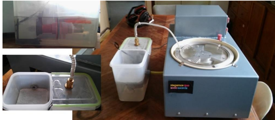
Figura 2.15: Imagen de pulidora mecánica construida ad-hoc y el sistema de circuito cerrado para reutilizar el agua que se utiliza para pulir
