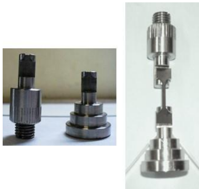
Figura 2.11 Imagen de las mordazas de carga rápida utilizadas en este trabajo y con una probeta de tracción
