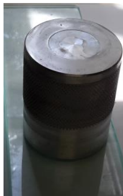
Figura 2.16: Dispositivo para pulir material irradiado
