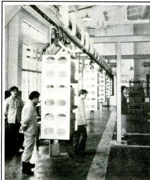
Estantes portadores de manzanas en cajas avanzan automáticamente hacia la cámara de irradiación en una instalación de Shanghai. (Fotografía del Boletín del OIEA, cortesía de Wedekind)
