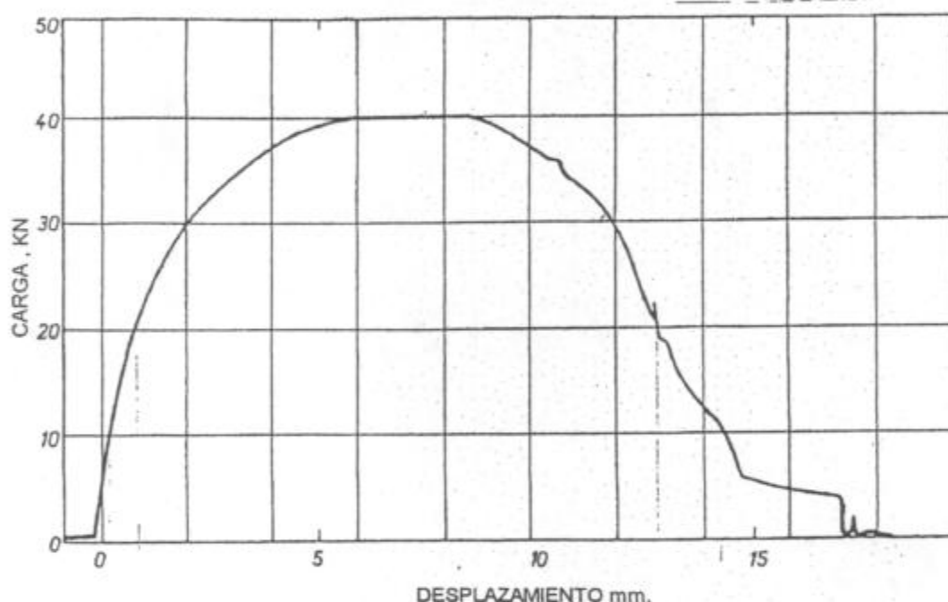
Fig.2.2.-Típico diagrama corte vs. desplazamiento en mm para una junta aluminio/acero inoxidable.
