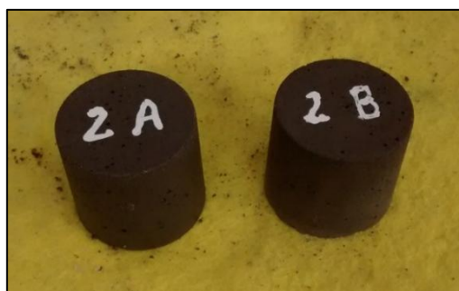
Figura 2-17. Probetas para medir carbonatación en los ambientes de humedad de laboratorio y 98% HR.
