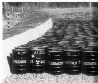
Tambores con residuos de baja actividad en almacenamiento temporario.
