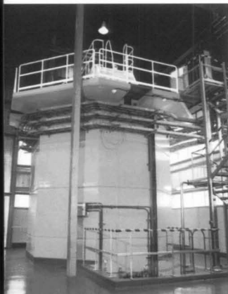
Reactor RA-8, donde se verifica el diseño neutrónico del núcleo.
