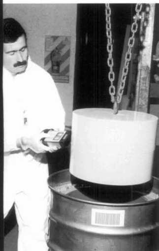
Medición de la dosis en contacto de contenedor de fuente agotada.
