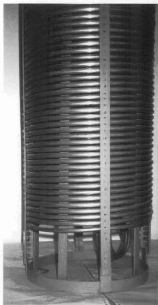
Desarrollo de generadores de vapor - autopresurizado y circulación natural, para proyecto CAREM.
