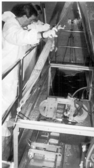
Mesa de corte bajo agua, en el momento en que es retirada de la piletta de trabajo para su mantenimiento.
