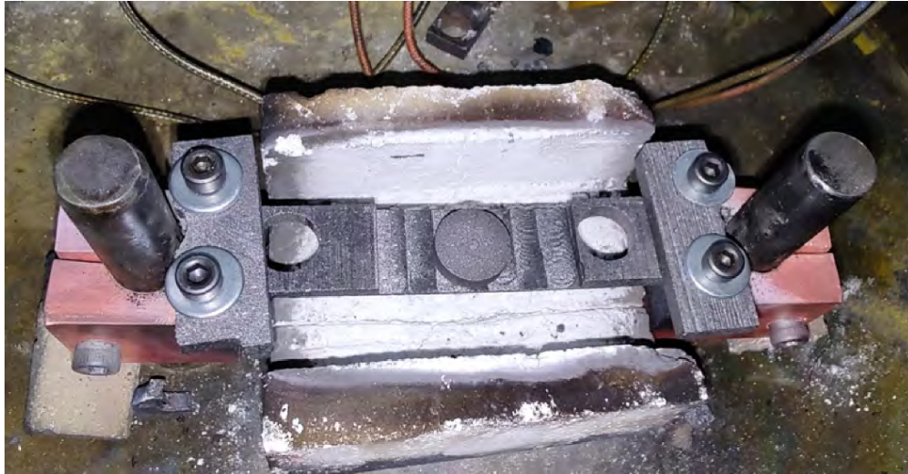
Figura 4.8: Dispositivo adaptado, para realizar los ensayos de grafitización en el equipo de PVD.
