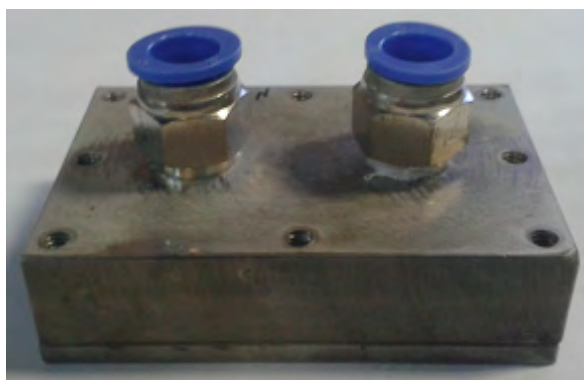
Figura 8.7: Prototipo de pruebas soldado mediante la técnica de soldadura por difusión en estado sólido.
