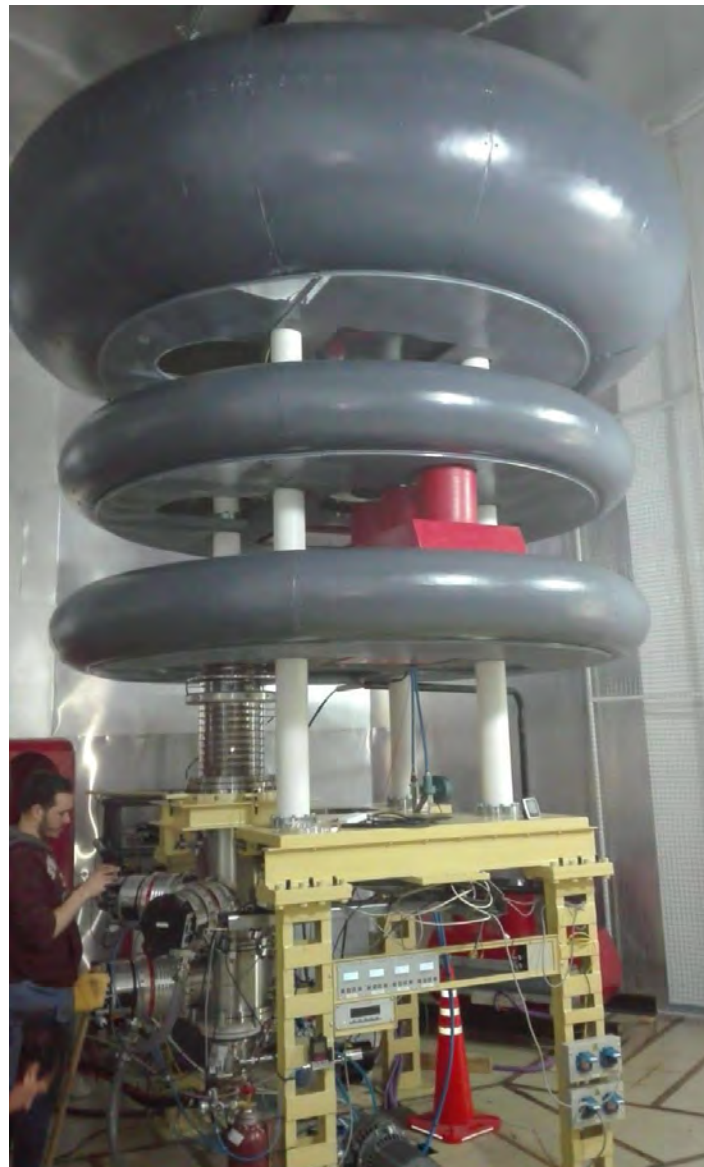
Figura 1.3: Acelerador electrostático de 720 kV de tensión de terminal.
