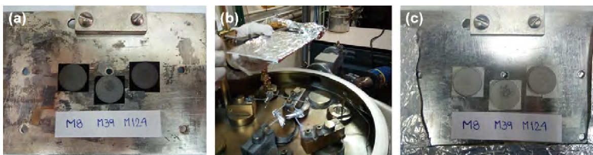
Figura 8.9: Imágenes del proceso de evaporación de aluminio, para obtener los depósitos sobre las muestras de carbono.
