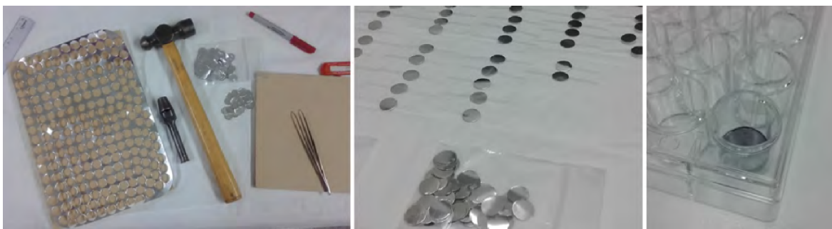
Figura 5.3: Fotos del proceso de elaboración de las canastitas individuales, para colocar las muestras de carbono en los portamuestras.
