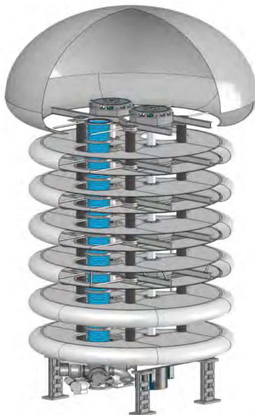
Figura 3.1: Esquema del acelerador en su versión final, con una fuente de iones en el domo a 1.5 MV combinada con una cadena de cuadrupolos electrostáticos.
