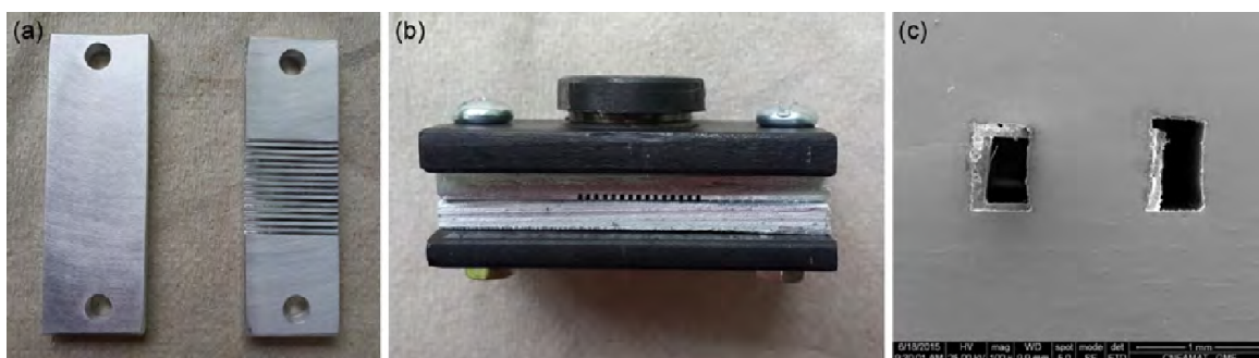
Figura 8.6: Imágenes de las segundas probetas mecanizadas con microcanales. (a) Probeta mecanizada con microcanales. (b) Probeta desbastada y colocada dentro de la prensa, antes de ser sometida al proceso de soldadura. (c) Microscopía SEM de un corte longitudinal de la probeta soldada.
