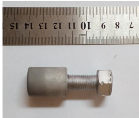
Figura 3-6 Arreglo tipo sándwich. Tratamiento térmico exitoso a 950°C.
