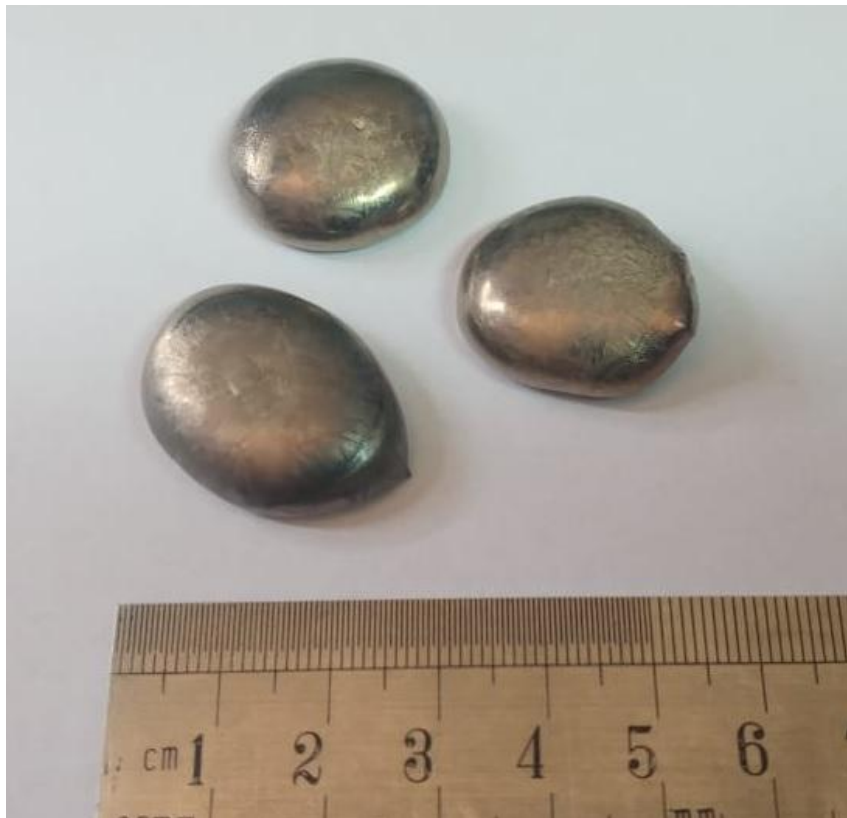
Figura A-1. Botones de aleación ternaria 97.4%wt Zr, 1.6%wt Er y 1%wt Nb.
