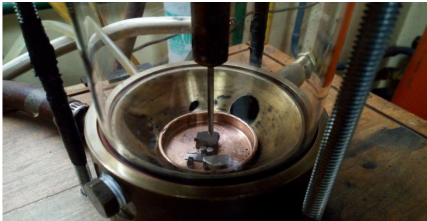
Figura 4-1 Preparación del botón 1 en horno de arco.
