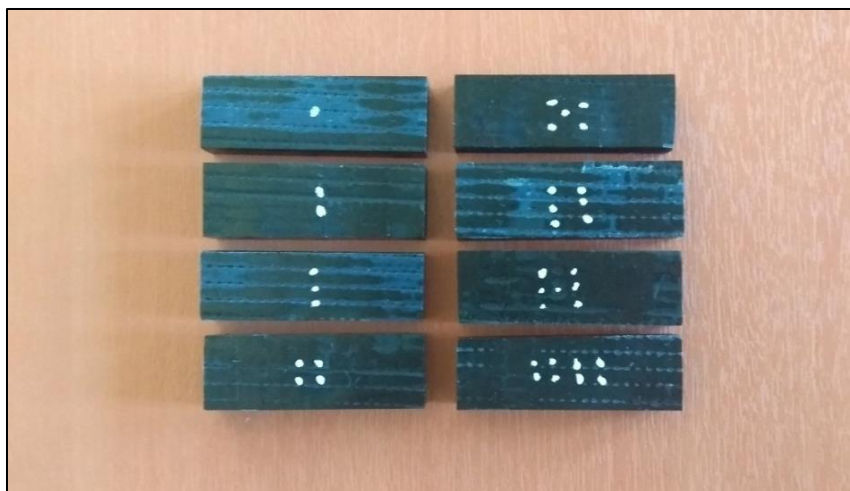
Figura 50: Probetas del lote KB terminadas (1,7 x 5 cm aproximadamente cada una).
