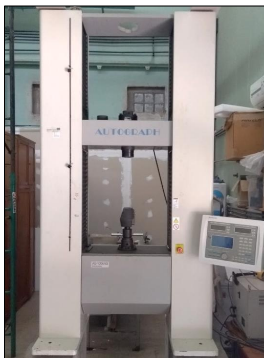
Figura 53: Máquina de ensayos universal servo-mecánica SHIMADZU 100 kNG.
