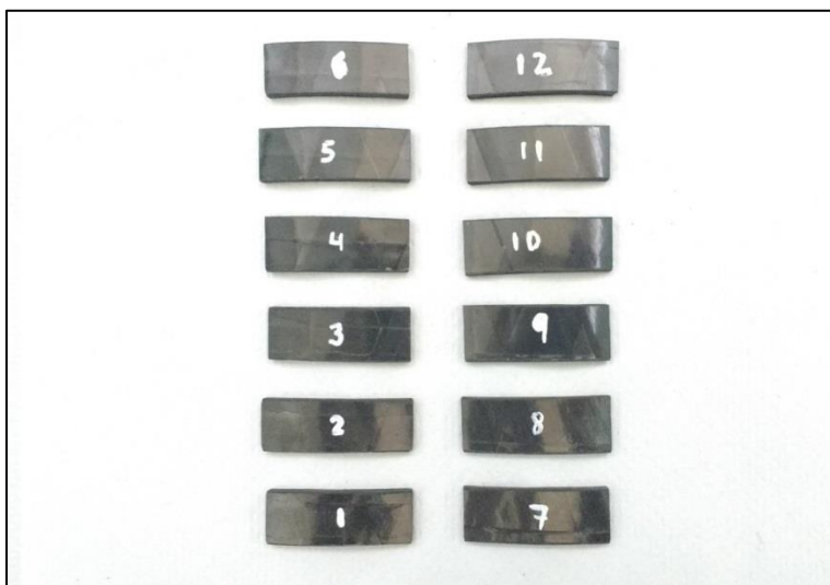
Figura 52: Probetas del lote KC terminadas (1,4 x 3,6 cm aproximadamente cada una).
