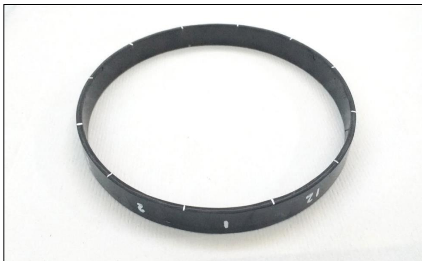
Figura 51: Sección del tubo circular a partir del cual se obtuvieron las probetas del lote KC (diámetro interno 17,42 cm).
