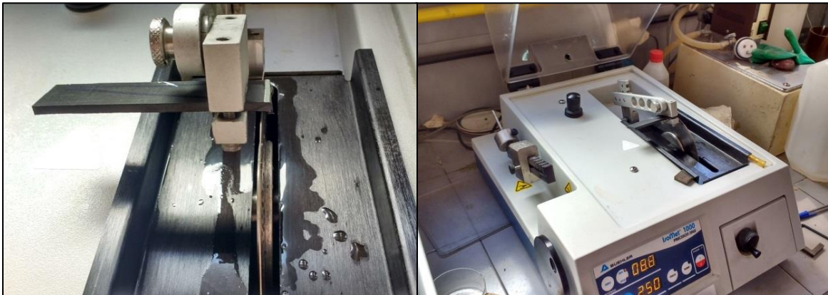
Figura 43: Corte de las tiras de material compuesto con la cortadora de disco diamantado.
