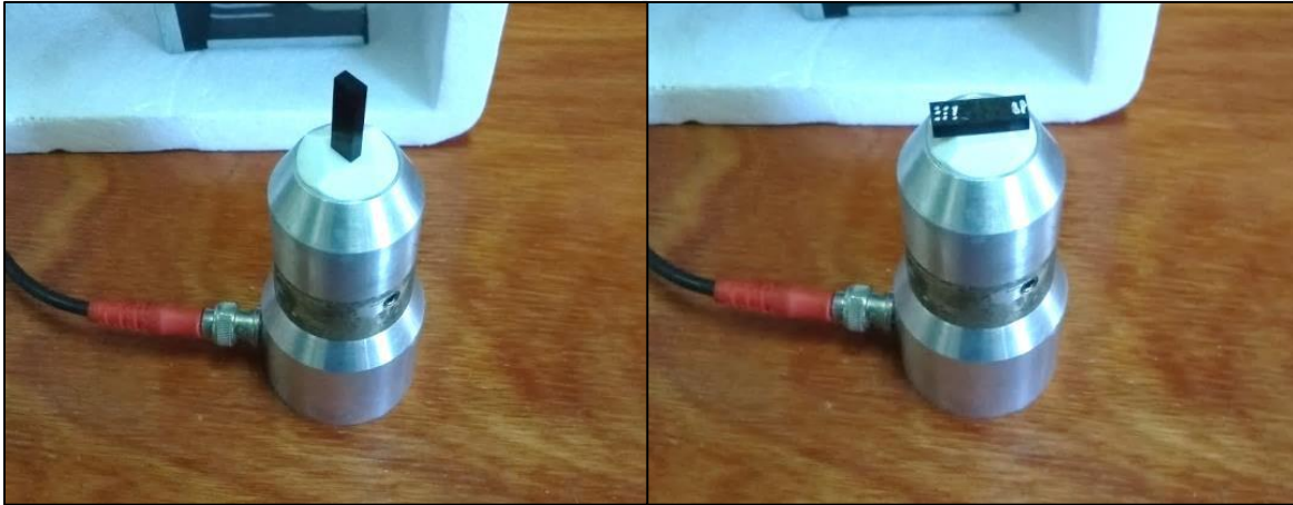
Figura 69: Medición por US de la velocidad del sonido en la dirección de las fibras (a) y normal a las mismas (b).
