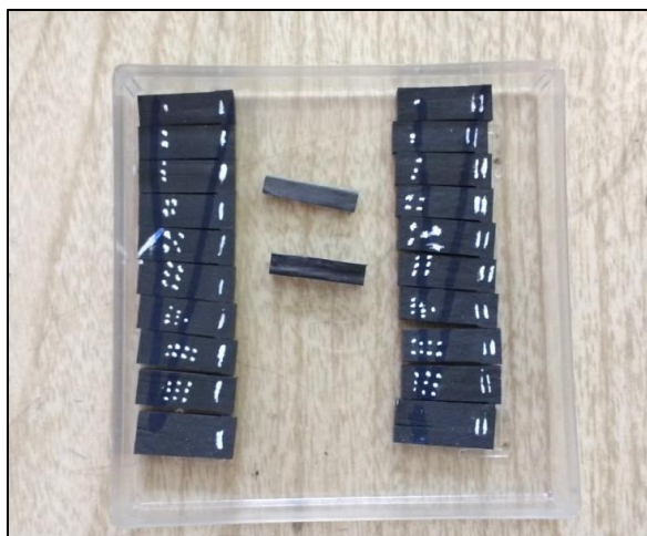
Figura 44: Pobretas para pruebas de flexión identificadas según su posición original en la placa antes de ser pulidas (7,67 x 22,60 mm aproximadamente cada una).
