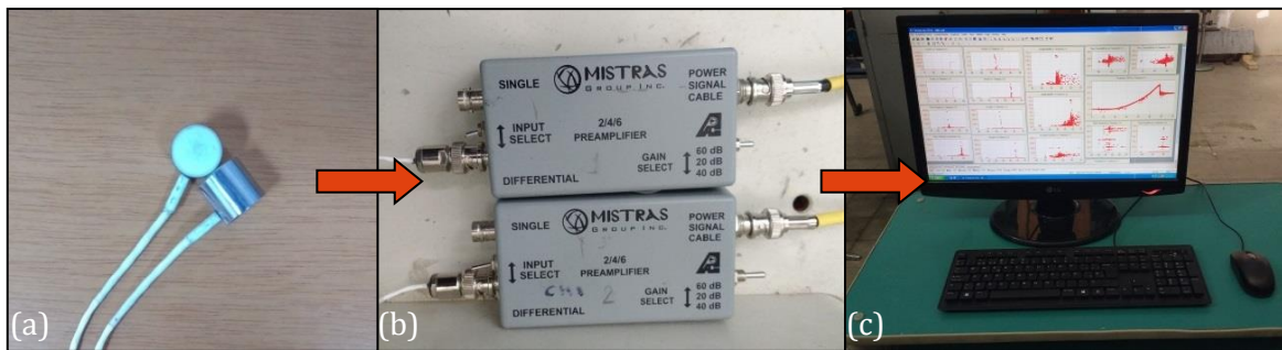
Figura 54: Componentes del sistema de medición de EA. (a) Sensores piezoeléctricos de banda ancha. (b) Pre amplificadores. (c) Interfaz gráfica de la placa de adquisición de datos.
