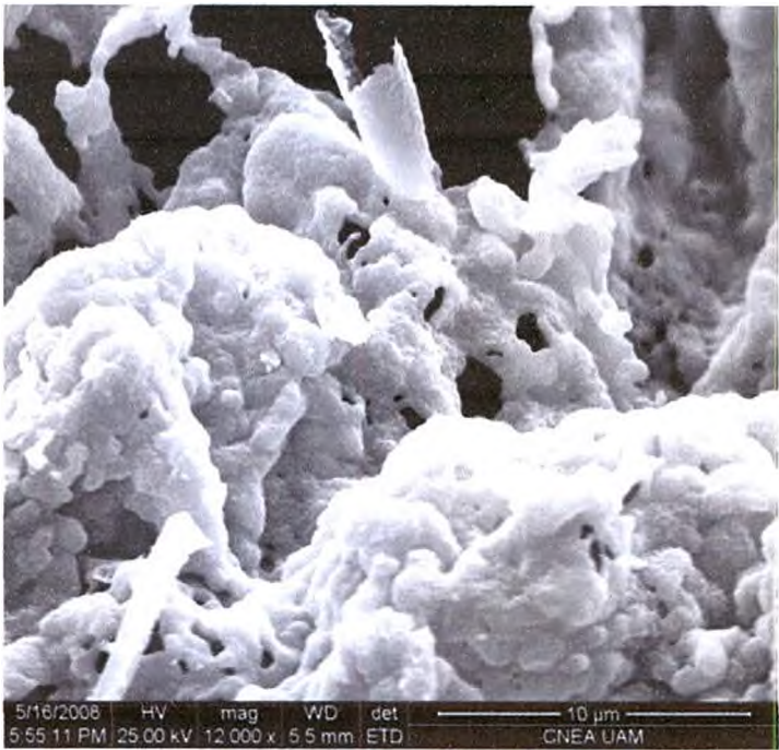
Figura 4.8. Micrografía SEM de la muestra \text{Co}_3\text{O}_4\text{-EC-Asp} .
