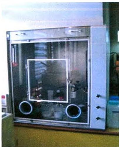
Figura 2.10. Cámara con atmósfera controlada donde se obtuvieron los óxidos mixtos.
