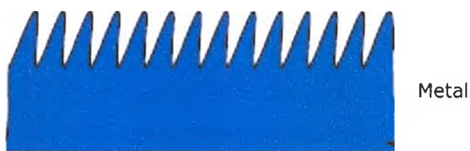
Figura 6.4. Superficie selectiva texturada.
