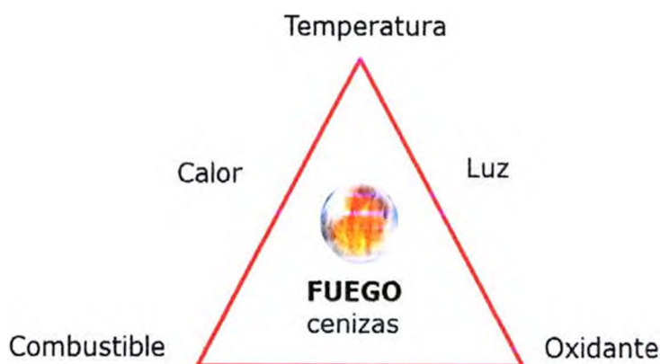
Figura 1.1 Triángulo de fuego
