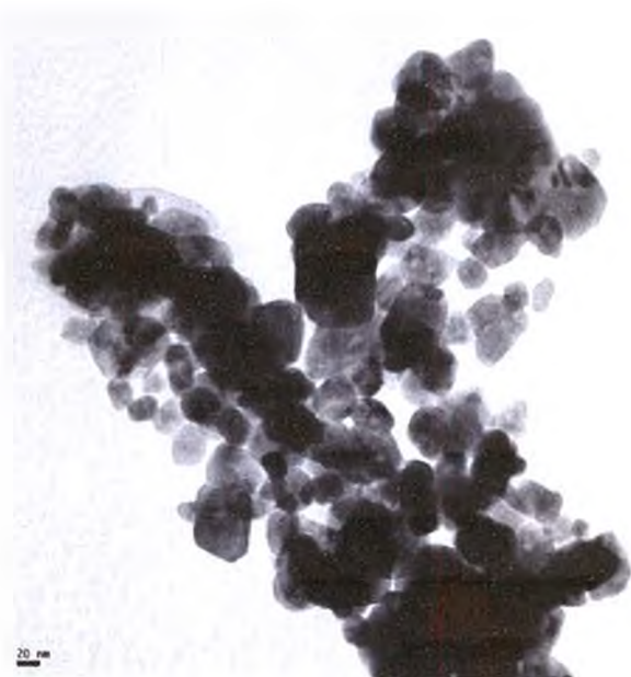
Figura 4.24. Micrografías TEM de la muestra: \text{Co}_3\text{O}_4 -EC-Lis.
