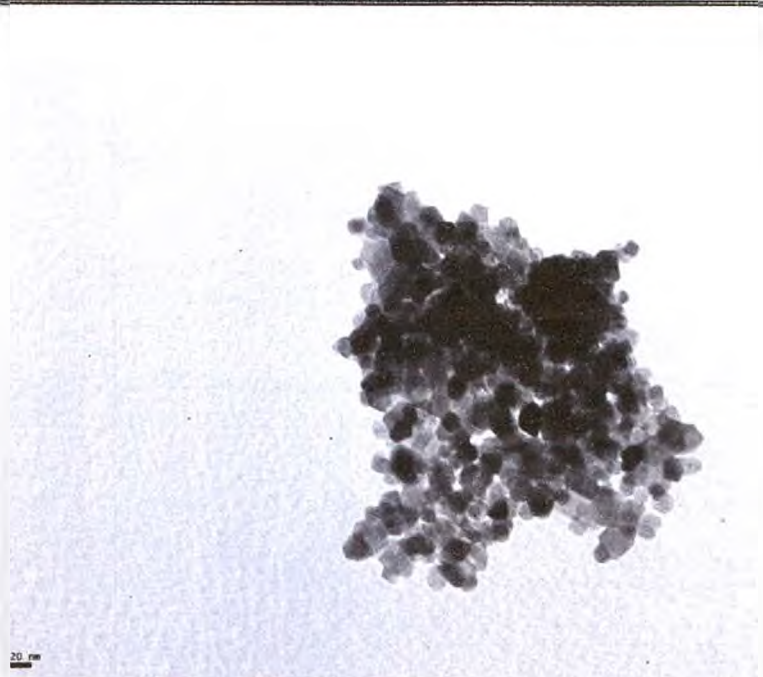
Figura 4.25. Micrografía TEM de la muestra \text{Co}_3\text{O}_4 -ES-Edta.
