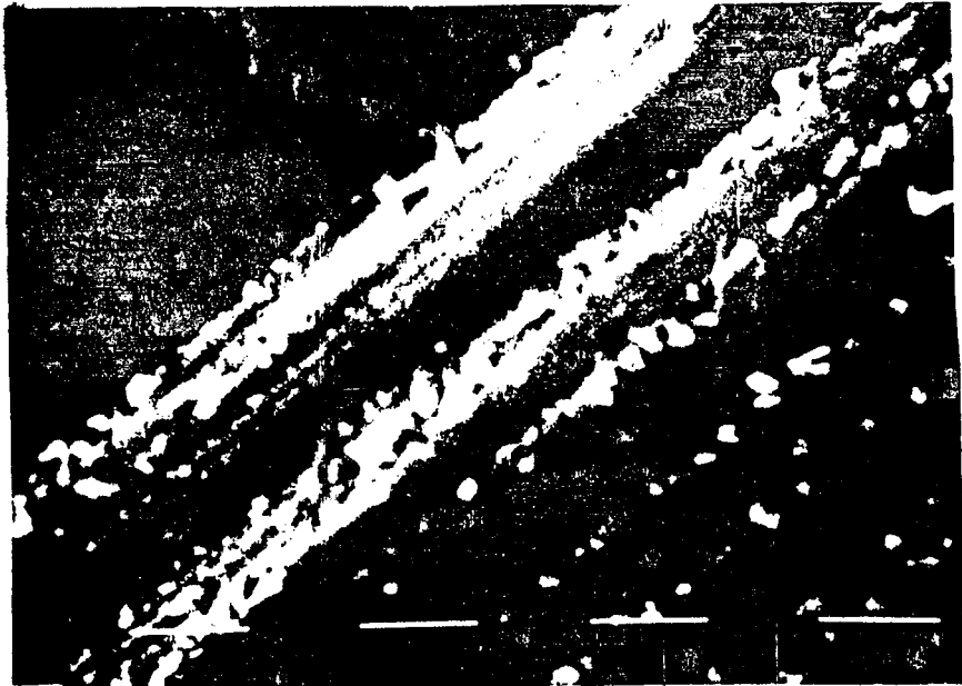
Fig. 34: Alambre de latón traccionado a 200 mV en solución de \text{NaNO}_2 1M a pH 10. Vista de la superficie que muestra la película superficial resquesbrajada. (12500 x)
