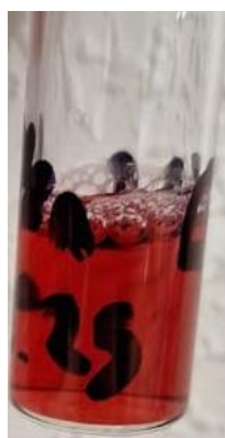
Figura 1: Suspensión coloidal de AuNSs de 20 nm, obtenida mediante síntesis por crecimiento asistido por semillas con la forma de nanovarillas.
