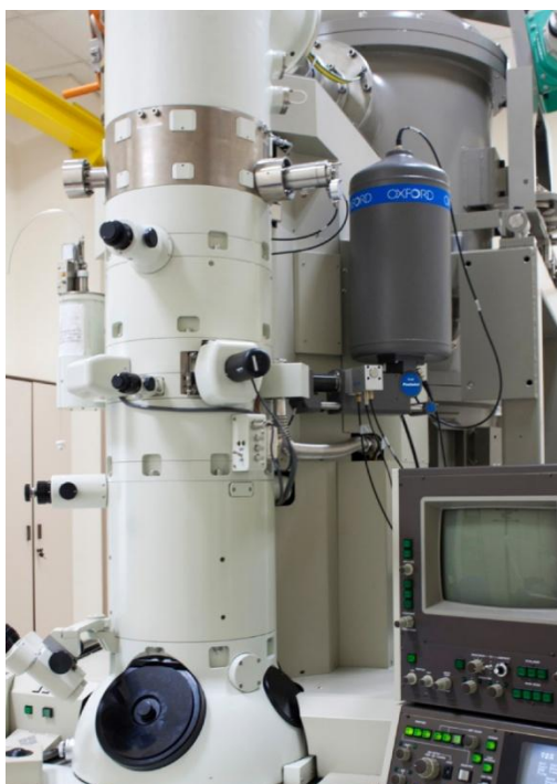
Figura 52: Imagen del microscopio JEOL JEM 3000F utilizado para el mapeo elemental.
