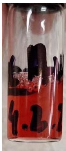
Figura 2: Suspensión coloidal de AuNSs de 20 nm, obtenida mediante síntesis por crecimiento asistido por semillas constituidas por nanoesferas de menor tamaño.
