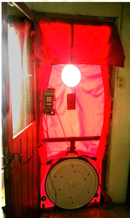
Blower Door instalado para comenzar el test.
