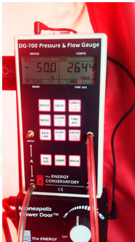
Manómetro digital empleado en el test. El valor de la izquierda de la pantalla indica la depresión de 50 pascales alcanzada. El de la derecha indica el caudal de aire expresado en CFM (“Cubic Feet per Minute” - Pies cúbicos por minuto), valor que se utiliza para realizar los cálculos.
