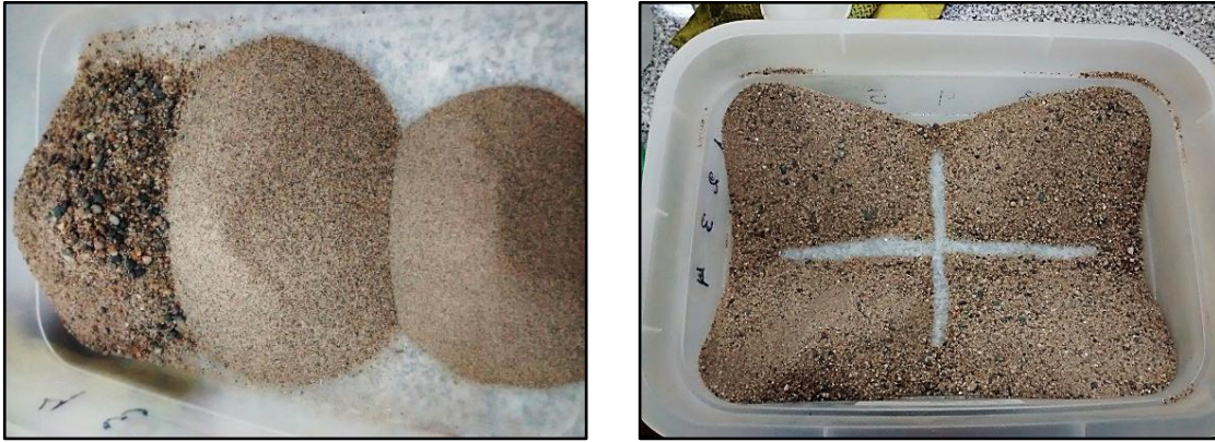
Figura 2.5 – Segregado post limpieza y cuarteo para garantizar la representatividad granulométrica.
