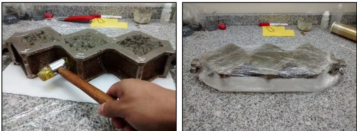
Figura 2.12 – Compactación general e impermeabilización del mortero
