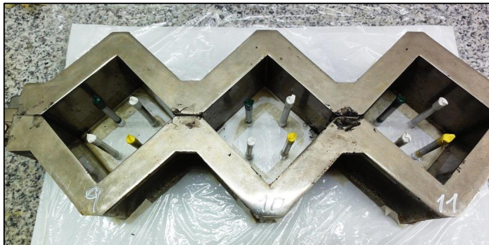
Figura 2.9 – Molde preparado para el colado.
