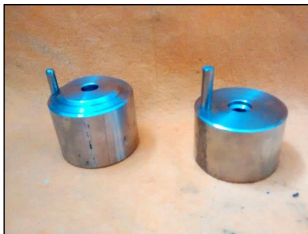
Figura 2.18 – Soportes utilizados como contraelectrodos externos.
