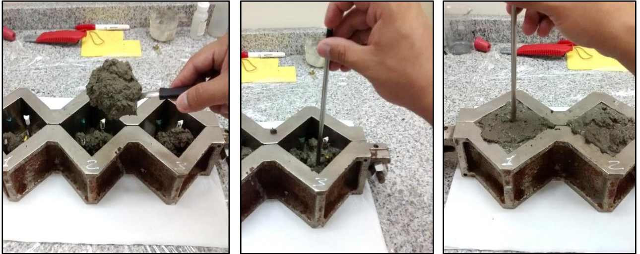
Figura 2.11 – Colocación y compactación por capas del mortero.
