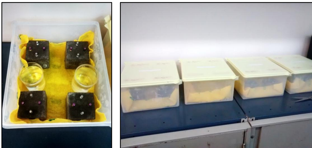
Figura 2.14 – Ambientes de 98% HR utilizados para curado y exposición
