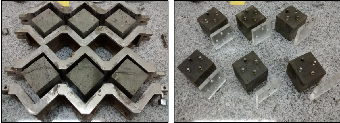
Figura 2.13 – Desmolde posterior al fragüe.
