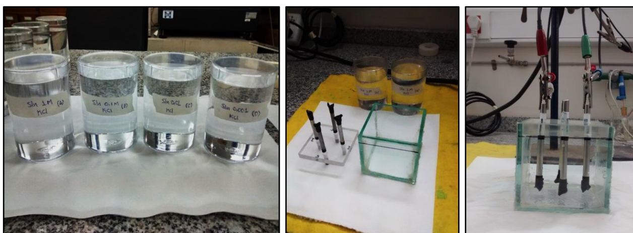
Figura 2.36 – Fabricación de la celda para determinar el coeficiente de forma geométrico ( K_F ).
