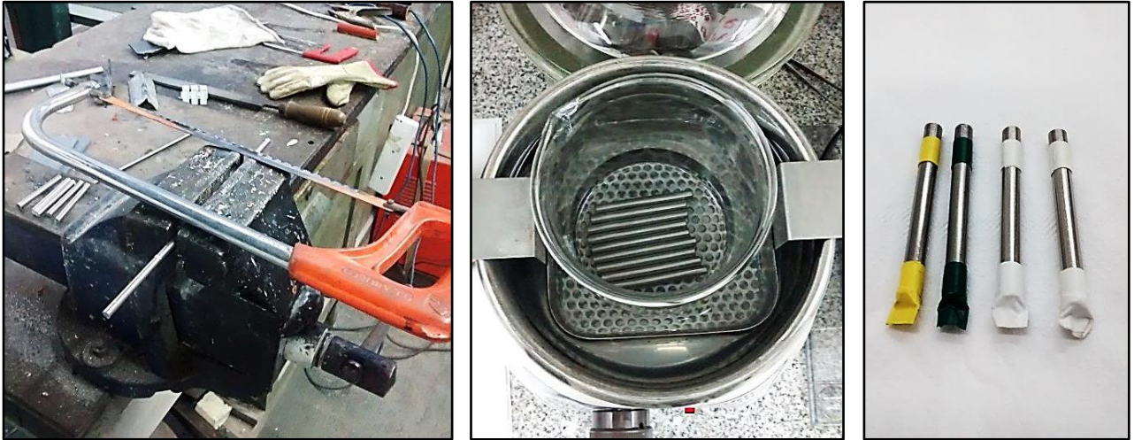
Figura 2.6 – Preparación de las barras de acero. Corte, limpieza y delimitación de área.
