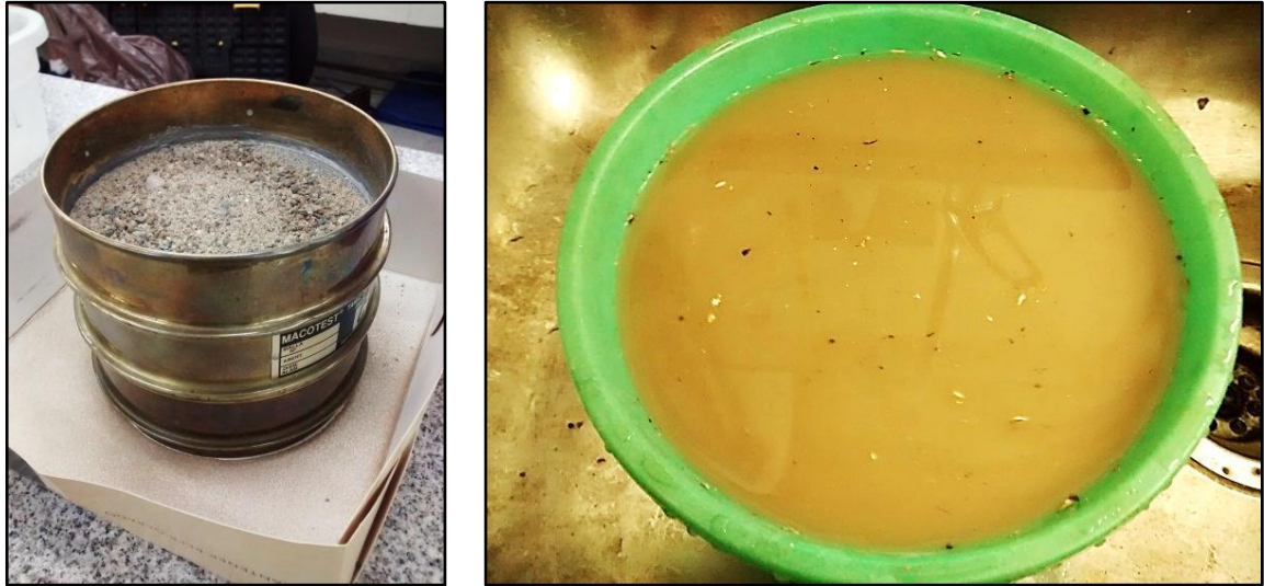
Figura 2.4 – Métodos de limpieza de agregados. Tamizado y lavado.
