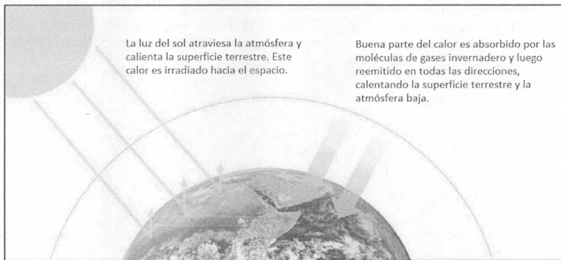
Figura 4. Cómo los gases invernadero producen calentamiento global.
