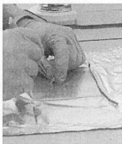
Figura 28. Procedimiento para la confección de una bola que contiene material a grafitizar.
