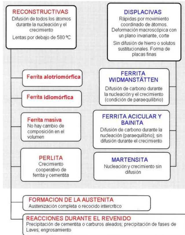
Figura 2.9. Características de las transformaciones en aceros [27].
