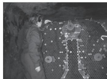
Ensayos No Destructivos Laboratorio de Corrientes Inducidas Inspección de un intercambiador de calor de central térmica Centro Atómico Constituyentes
