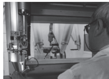
Laboratorio de Ensayos Pos Irradiación Celda blindada con telemanipulador Centro Atómico Ezeiza
