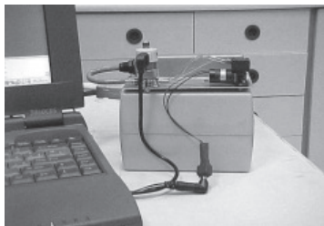
Sistemas de micro-electro mecanismos (MEMS) - Prototipo de nariz electrónica Centro Atómico Constituyentes
