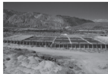
Producción de concentrado de uranio Pilas de lixiviación
