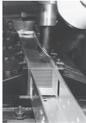
Elementos combustibles tipo MTR para el reactor de investigación RA-3 fabricados por CONUAR S.A.
