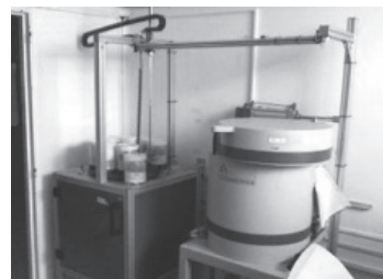
Laboratorio de Metrología de Radioisótopos Intercambiador de muestras Detector de germanio hiperpuro Centro Atómico Ezeiza
