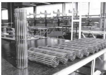
Elementos combustibles tipo CANDU para la Central Nuclear Embalse fabricados por CONUAR S.A.
