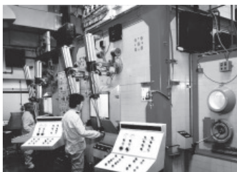
Planta de Fabricación de Generadores de Molibdeno-99/Tecnecio-99 Celdas blindadas con telemanipuladores Centro Atómico Ezeiza
