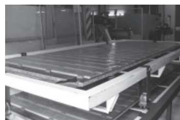
Proyecto Antena Radar de Apertura Sintética Modelos para ensayos de caracterización de radio frecuencia
