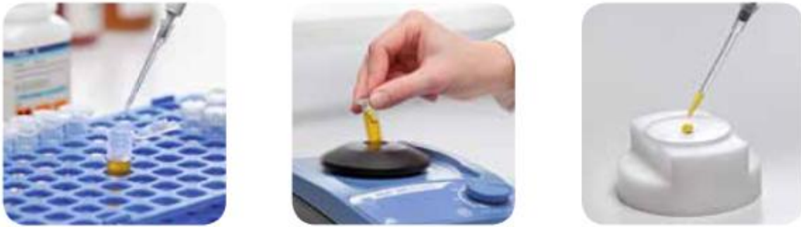
Figura 25. Pasos a seguir para preparación de muestras. A) Agregado de Estándar Interno. B) Homogenización de la solución. C) Pipeteado de la solución en disco reflector.
