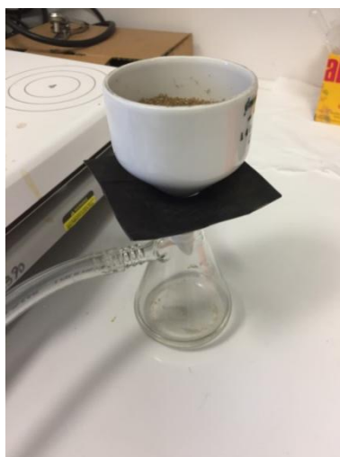
Figura 30. Embudo Büchner con resinas húmedas conectado al kitasato y bomba de vacío.
