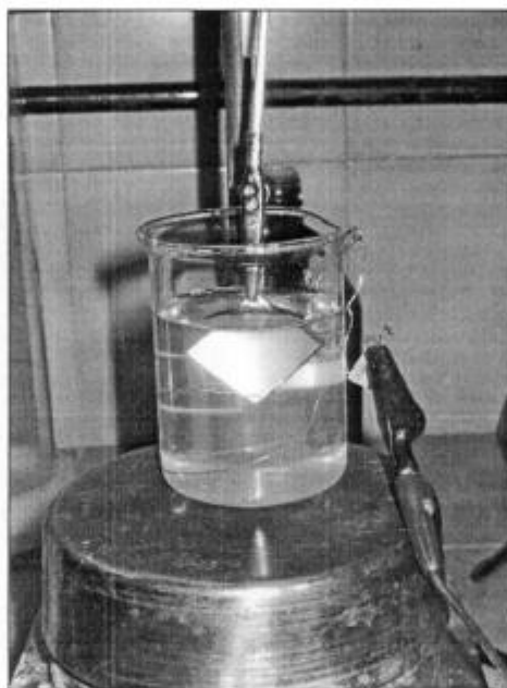
Figura 4.1: Probeta en proceso de depósito de capa superficial de paladio
