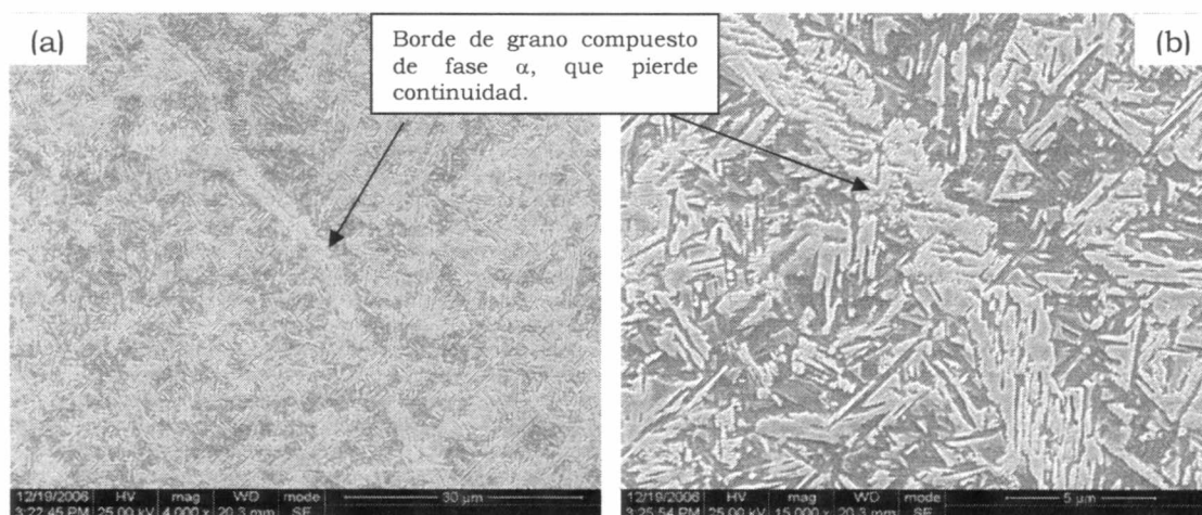
Figura 23: Foto obtenida mediante MEB de la probeta A2.
