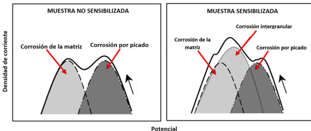
Figura 4.4: Diagrama esquemático de deconvolución de la curva de reactivación en el ensayo DL-EPR en solución de \text{H}_2\text{SO}_4 + \text{KSCN} para una muestra sensibilizada y una no sensibilizada.
