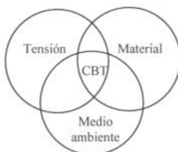
Figura 24: Condiciones en las que aparece la corrosión bajo tensión [46].
