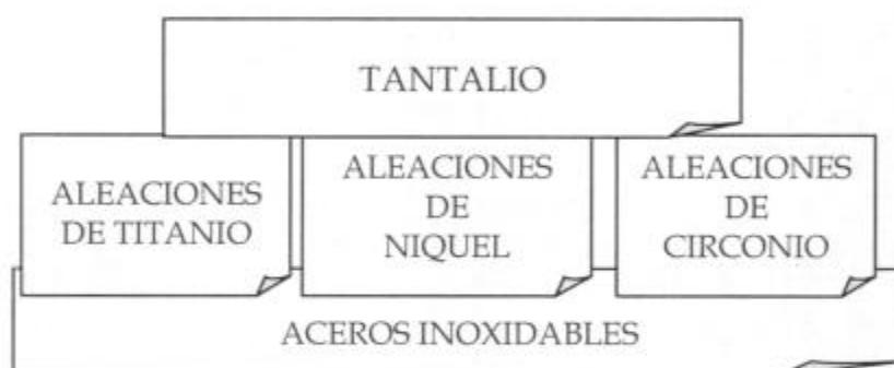
Figura 6: Comparación de la resistencia frente a la corrosión de las diferentes familias de aleaciones [19]. La resistencia a la corrosión desciende hacia abajo.
