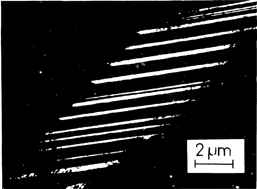
Fig 7: Campo oscuro de martensita maclada (variante 2)
