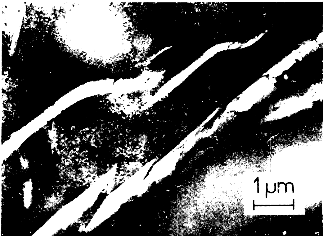
Fig. 8: Microscopía electrónica de martensita (morfología combada)
