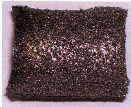
c. Fotografía con lupa de una esponja de Nb5.5
