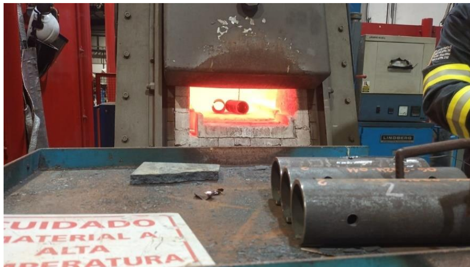
Figura 11: Probetas siendo introducidas en la mufla LINDBERG para realizar un austenizado a 1000 °C.
