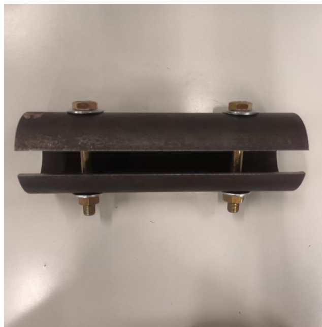
Figura 10: Foto de la probeta a ensayar, incluyendo los tornillos pasantes, tuercas y arandelas.
