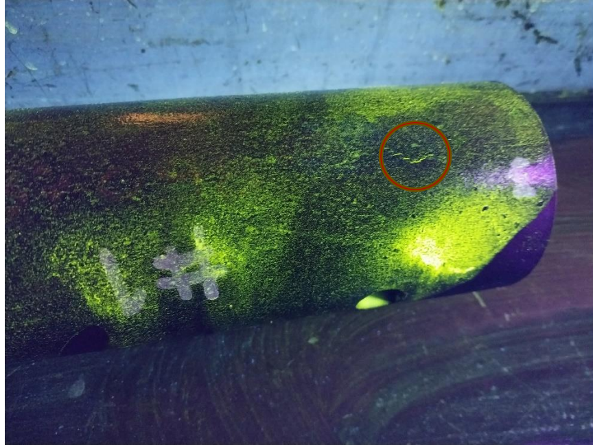
Figura 39: Detalle de indicaciones detectadas con partículas magnéticas.
