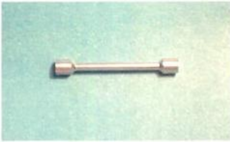
Figura 3.1: Probetas de tracción (dimensiones en mm)
