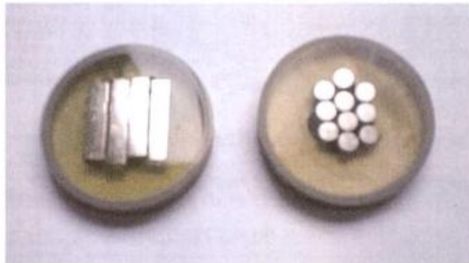
Figura 3.3: Matrices de Circonio longitudinales y transversales
