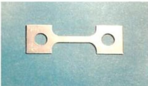
Figura 3.2: Probeta de Zircaloy-4 (dimensiones en milímetros)
