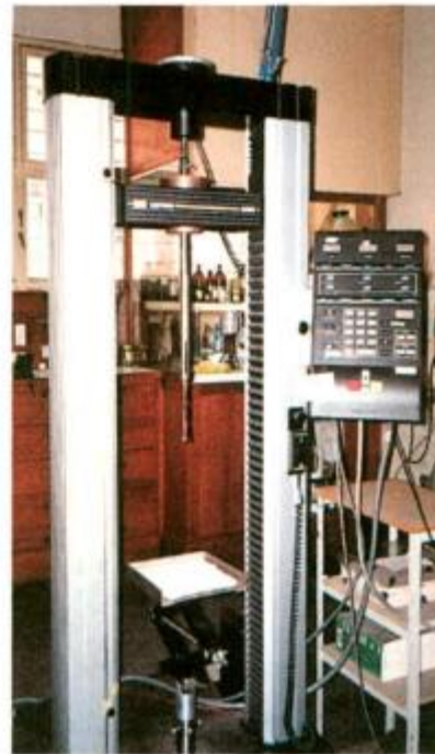
Figura 3.9: Esquema de una máquina de tracción y foto de la Instron modelo 4465 utilizada en este trabajo
