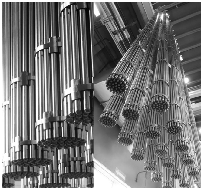
Elementos combustibles para el reactor nuclear de potencia Atucha I. CONUAR, Provincia de Buenos Aires.
