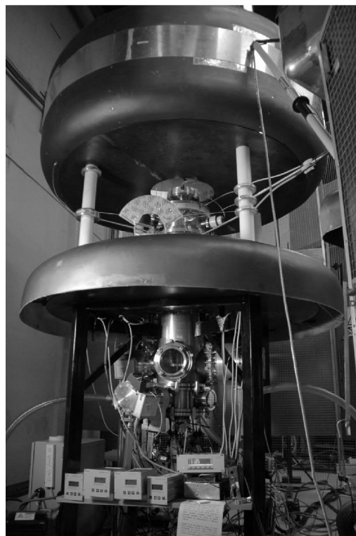
Acelerador de partículas desarrollado para el tratamiento de cáncer a través de la Terapia por Captura Neutrónica en Boro (BNCT). Centro Atómico Constituyentes, Provincia de Buenos Aires.
