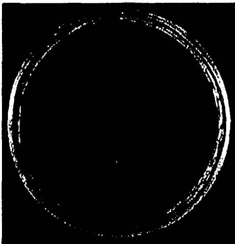
Fig. 96 — Tubo sem emenda (Mannesmann), neste caso caracterizado pela localização de uma segregação contínua na face interna do tubo. A faixa clara externa é de material mais puro. Ataque: iodo. Tamanho natural.
