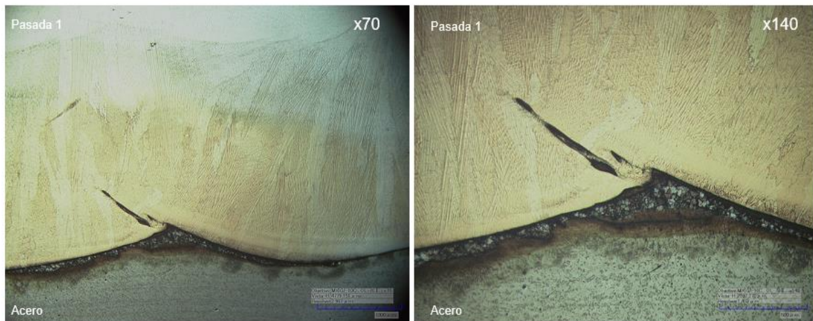
Figura A 3: Manchas rojizas producidas por neutralizar con agua en vez de etanol el cladding en muestras que contienen acero. Reactivo Kalling.
