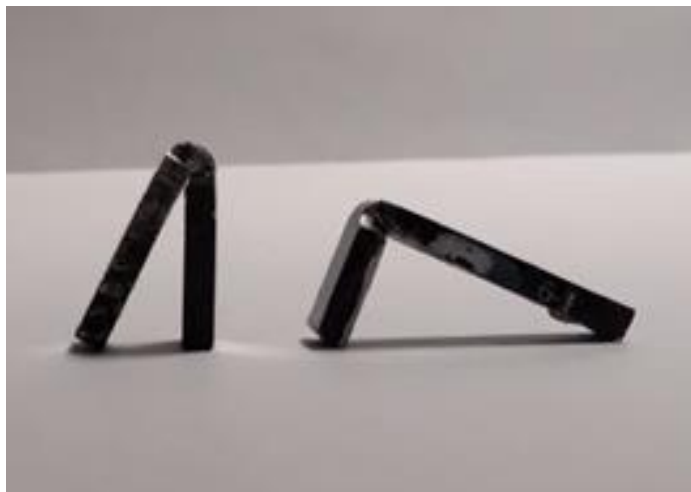
Figura 5.47: Intento fallido para abrir las fisuras por nitrógeno líquido para su observación.
