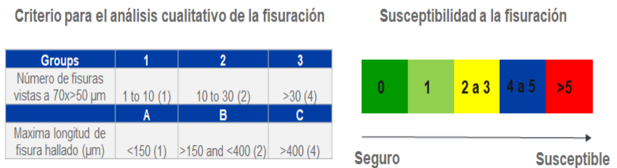
Figura 5.38: Criterio para el análisis cualitativo de la fisuración con su respectivo código de colores.
