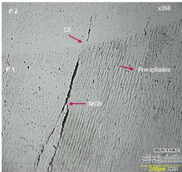
Figura 5.33 A la izquierda muestra #2 ( T=1100\text{ }^{\circ}\text{C} , \epsilon=10.8\% ), a la derecha muestra #13 ( T=1050\text{ }^{\circ}\text{C} , \epsilon=9.70\% ). Debe destacarse que aún después de la deformación en Gleeble a la más alta temperatura ensayada todavía hay presencia de precipitados.
