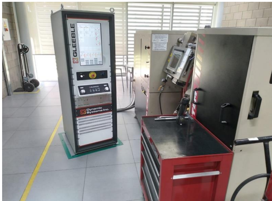
Figura 4.4: Simulador termomecánico Gleeble 3500, REDE-AR de Tenaris SIDERCA
