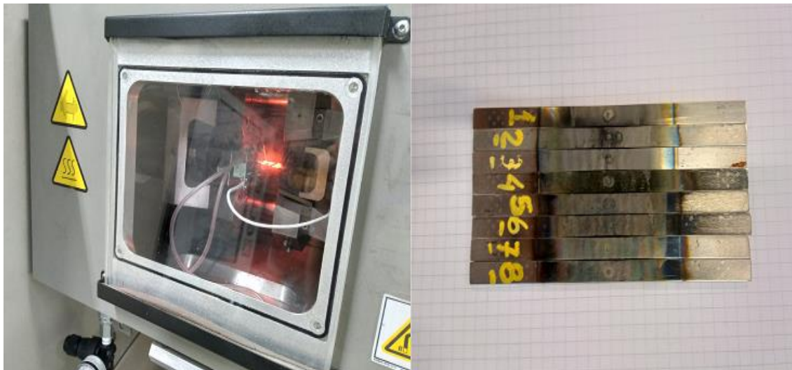
Figura 4.9: A la izquierda, muestra en la cámara de Gleeble (ensayo en curso). A la derecha, muestras después del ensayo levemente oxidadas.
