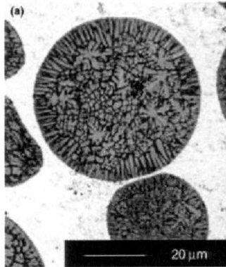
Figura 2.4: Corte metalográfico del núcleo de una placa de elemento combustible disperso de alta densidad. Se aprecia una partícula de material combustible sin irradiar, [11].
