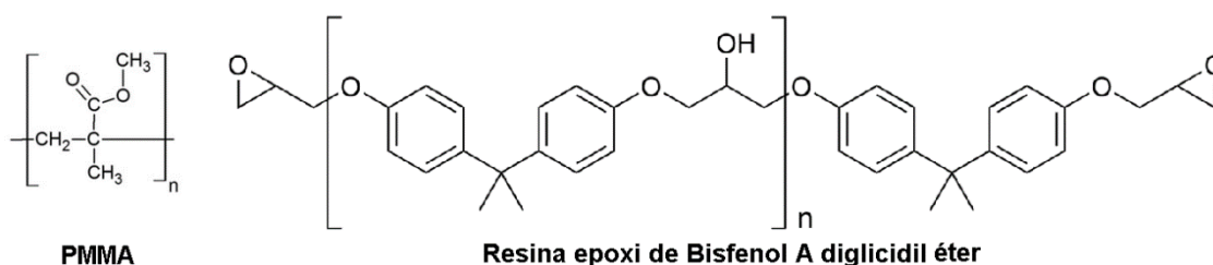
Figura V-3. Estructuras químicas de los dos polímeros utilizados: PMMA y Resina Epoxi.
