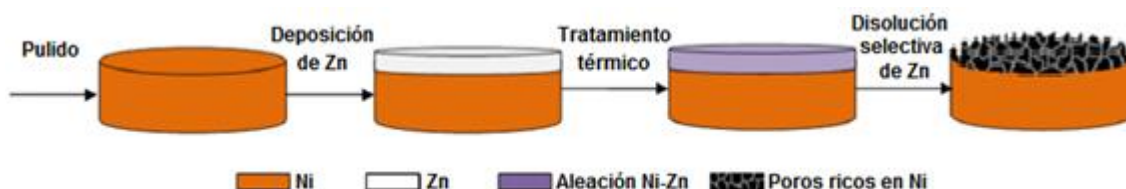
Figura IV-1. Etapas en el proceso de fabricación de electrodos mesoporosos de Ni. Modificado a partir de la referencia [18].
